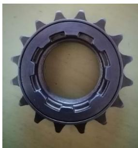
Este piñón tensor tiene la ventaja de adaptarse a un eje de bicicleta (“Manzana”) gracias a su rosca interna y el rodamiento que tiene integrado, para poder fijarlo a la mesa se diseñó una bancada como se muestra en la **Figura 57 (b)**.
