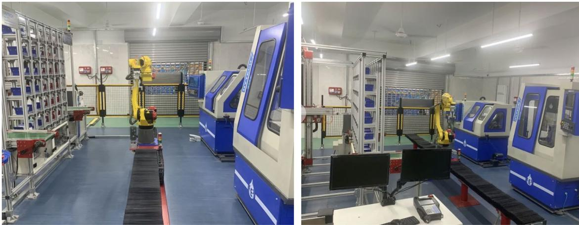
Este CIM tipo 1 tiene una distribución muy particular, el cual consta con un manipulador antropomórfico centralizado con desplazamiento lineal, encargado de la alimentación de la materia prima en las estaciones y de la extracción de los productos para organizarlos en un sistema automático de almacenamiento y recuperación.
