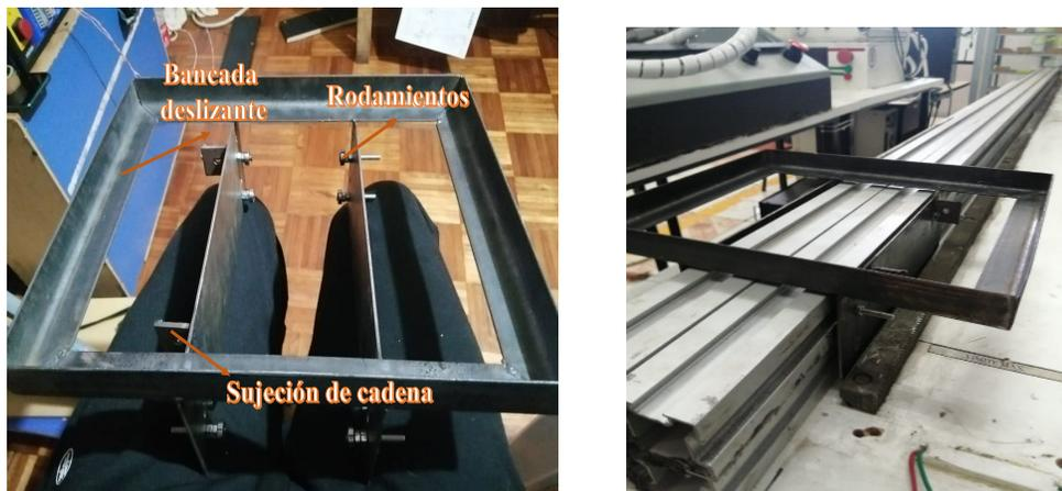
Las bancadas del piñón tensor y el piñón motor se implementaron como se muestra en la **Figura 65** y se fijaron sobre la mesa de soporte principal a cada una de las esquinas del sistema de guiado para transmitir el movimiento con la cadena como muestra la **Figura 66**.
