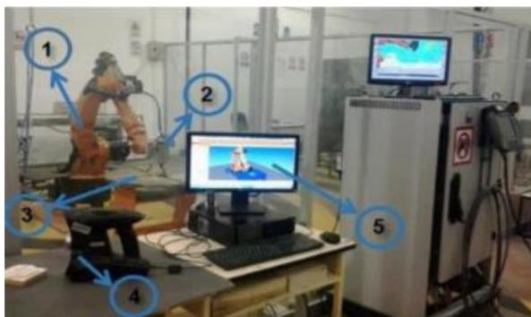
*Nota.* Celda de manufactura robotizada para replicar piezas en 3D desarrollada en la Universidad de las Fuerzas Armadas ESPEL que consta de las partes 1. Brazo robótico KUKA
