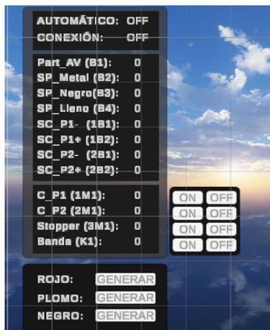
La información que se proporciona a través del canvas contiene los sensores, actuadores de la estación MPS clasificación, de igual forma incluye la creación de los tres tipos de objetos a clasificar, así como de la posibilidad de accionar botones para el encendido o apagado de los actuadores de la estación.
