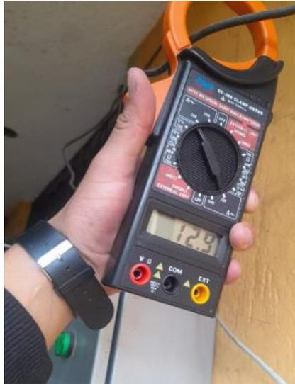
*Nota.* Corriente de arranque del motor.
