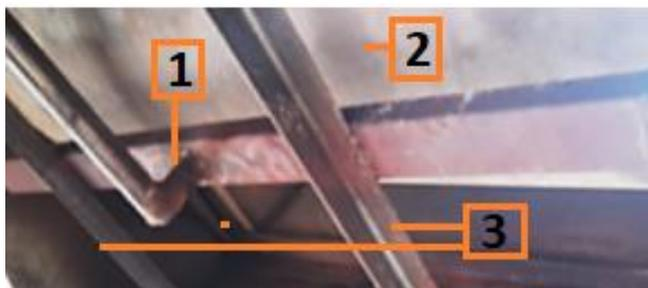
*Nota.* 1. Quemador, 2. Cilindro tostador, 3. Estructura base
