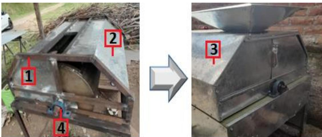
*Nota.* 1. Base hexagonal, 2. Cubierta interna, 3. Cubierta externa, 4. Chumacera UCP-209
