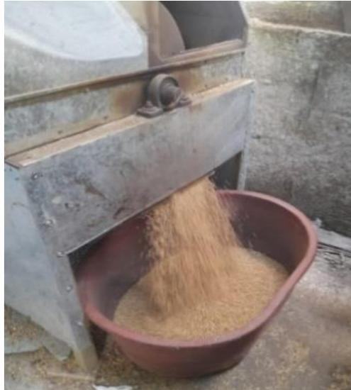
La extracción del grano se lo realiza con total normalidad, logrando extraer el 100 % del grano del cilindro de tueste y no presenta desperdicio de grano en el traspaso al recipiente de almacenamiento.
