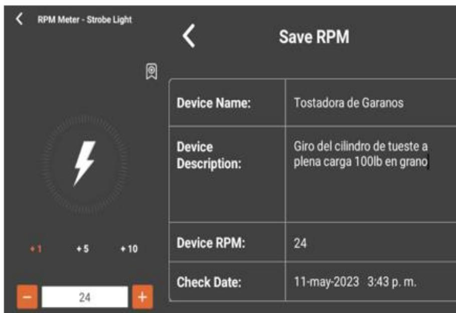
El número de revoluciones por minutos planteados en el diseño de detalle es de 29 rpm y el número de revoluciones reales es de 24 rpm. Esta diferencia expuesta entre el rpm real y la diseñada se da por la utilización del motor otorgado por la microempresa Bonilla Camino al ser este de segunda mano.
