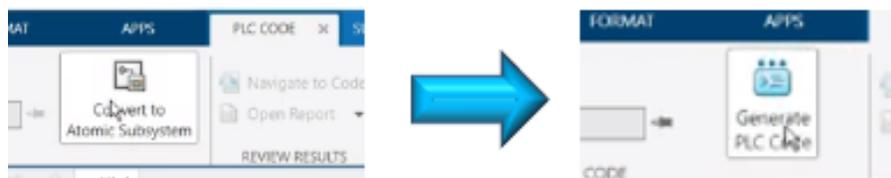
El código generado se guarda en un archivo de extensión ST (Structured Text), como se muestra en a Figura 74, para insertar este código al PLC hay que copiar el código generado y pegarlo en el sub proyecto de TIA Portal del PLC S7-1200. Para lo cual se crea una nueva red de programación y se agrega un bloque de tipo función FC (Function Block) en el TIA Portal y se selecciona como lengua de programación SCL (Structured Control Language).
