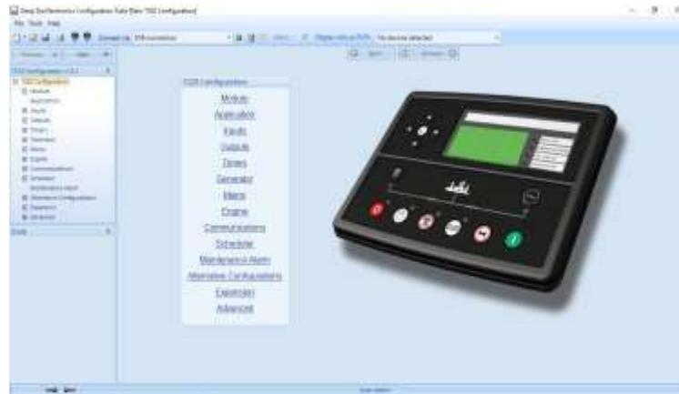
En esta pantalla, continúe ingresando los parámetros para su fuente de energía primaria, o preferiblemente equivalente. Seleccione el tipo de configuración de voltaje a usar.
