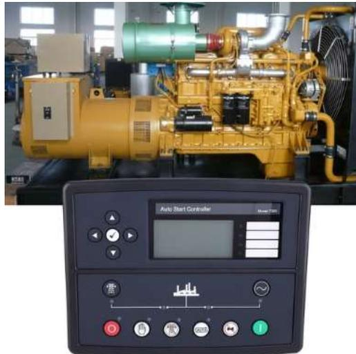
Después de una interrupción normal de la red, cuando el grupo se enciende y alcanza el modo de operación continua, el controlador envía una señal para abrir el interruptor de emparejamiento de la barra y luego de un tiempo envía una señal. Señal de apagado de la red de emergencia, fin de la secuencia de conmutación entre la red eléctrica de la red pública y la red eléctrica de emergencia
