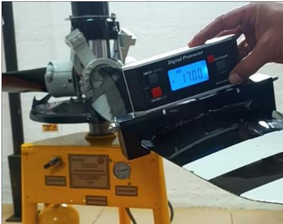
La evaluación de este ángulo de la hélice o como se mencionó anteriormente para que la hélice este en paso alto, se realizó de manera satisfactoria ya que, con una presión de 100 psi, el ángulo de las palas llegó a 17°, como se muestra en la Figura 38.
