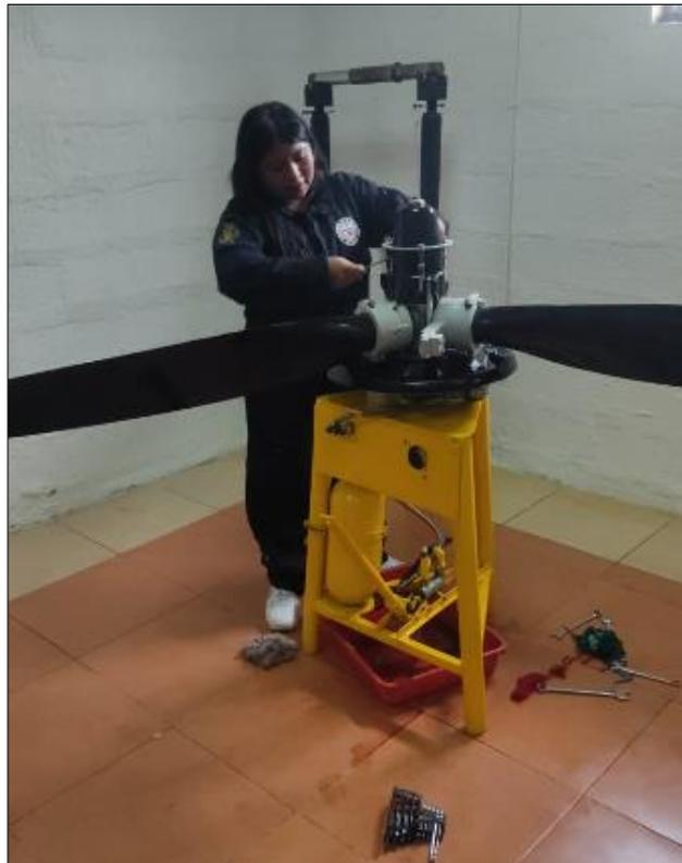
Luego se instaló la hélice sobre el banco de pruebas y se ajustó los pernos de sujeción al torque recomendado por el manual.
