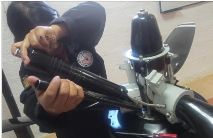
Se utilizó la grasa mineral MIL-G-25537C, también conocida como Aero Shell Grease 14, es un tipo de grasa lubricante utilizada en aplicaciones de aviación y aeroespaciales. Esta grasa se utiliza comúnmente en rodamientos, cojinetes y otras áreas donde se requiere una lubricación de alta calidad en condiciones exigentes. Como se muestra en la Figura 34.
