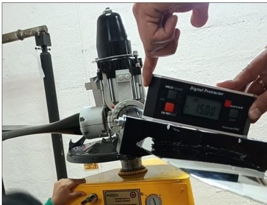
La evaluación de este ángulo de la hélice o como se mencionó anteriormente para que la hélice este en paso de reversa, se realizó de manera satisfactoria ya que, con una presión de 150 psi, el ángulo de las palas llegó a  $-15^\circ$ , como se muestra en la Figura 39.
