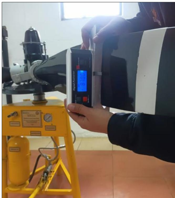
La evaluación de esta posición resultó satisfactoria como muestra en la figura anterior., hay que recalcar que la hélice recibe la presión inicial del motor que es de 80 +/-10 psi en la aeronave. Pero en el banco de prueba en el estado inicial, la hélice ya tiene sin presión la
