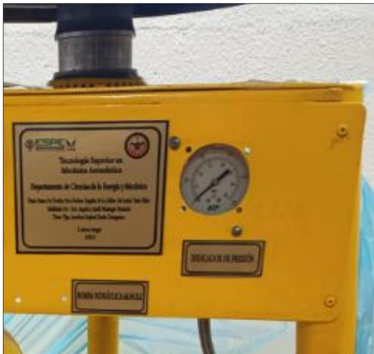
Por tal razón, se envió a calibrar el manómetro del banco de pruebas ya que para realizar la evaluación de ángulos de la hélice es necesario tener lecturas precisas y correctas cuando se proporcione presión al sistema.
