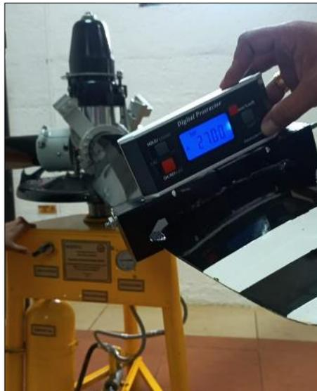
La evaluación de este ángulo de la hélice o como se mencionó anteriormente para que la hélice este en paso fino, se realizó de manera satisfactoria ya que, con una presión de 85 psi, el ángulo de las palas llegó a  $27^\circ$ , como se muestra en la Figura 37.
