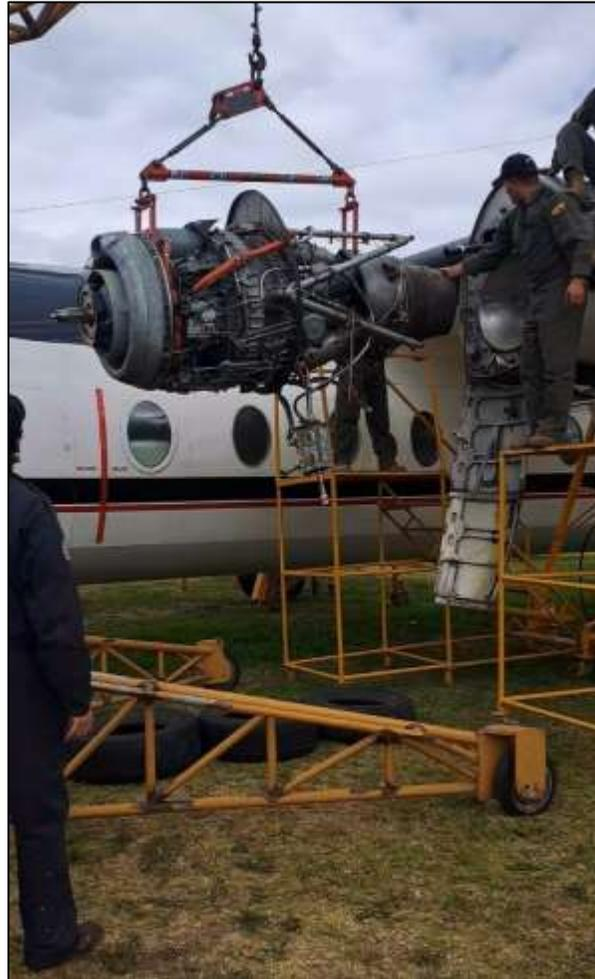
*Nota.* Desmontaje del motor Rolls Royce Dart.
