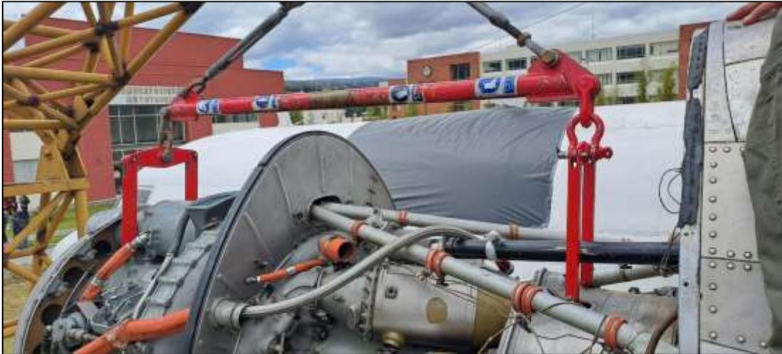
*Nota.* La imagen muestra el tubo estructural del motor Rolls Royce Dart
