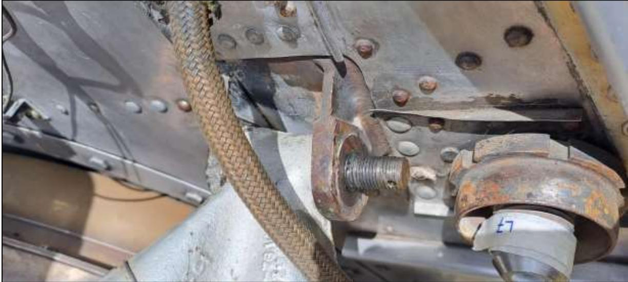
*Nota.* Ubicación de los pernos del eje impulsor del motor Rolls Royce Dart.
