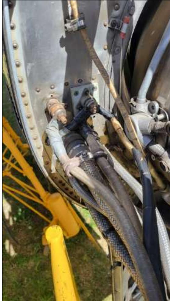
*Nota.* La imagen muestra los plugs del motor Rolls Royce Dart.
