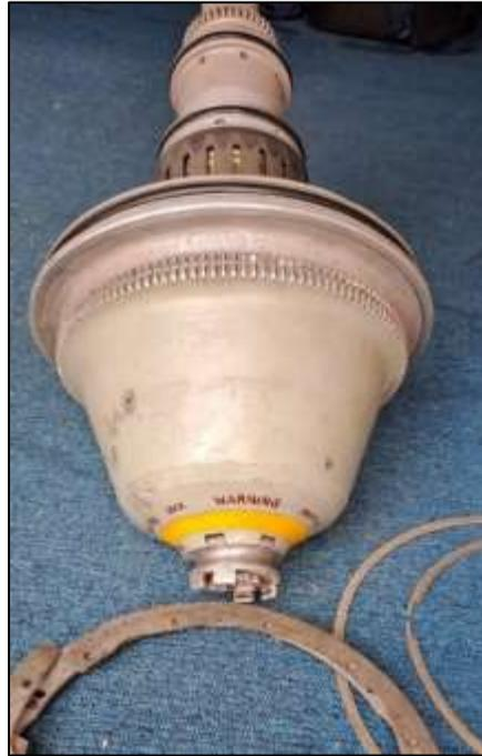
*Nota.* La imagen muestra el pitch lock ya extraído de la aeronave
