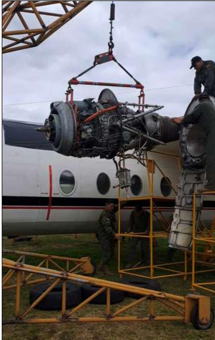
*Nota.* Prueba de funcionamiento del tecele, mediante el desmontaje del motor de la aeronave Fairchild FH-227
