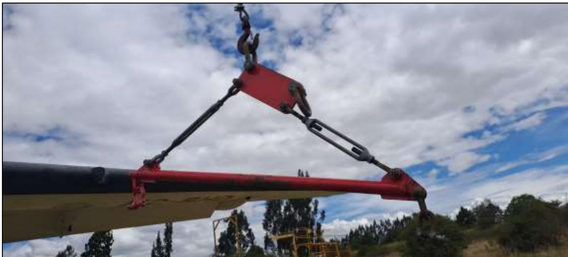
*Nota.* Eslingas utilizadas para el desmontaje del motor Rolls Royce Dart.
