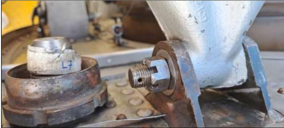
*Nota.* Herrajes de sujeción del motor a los montantes.
