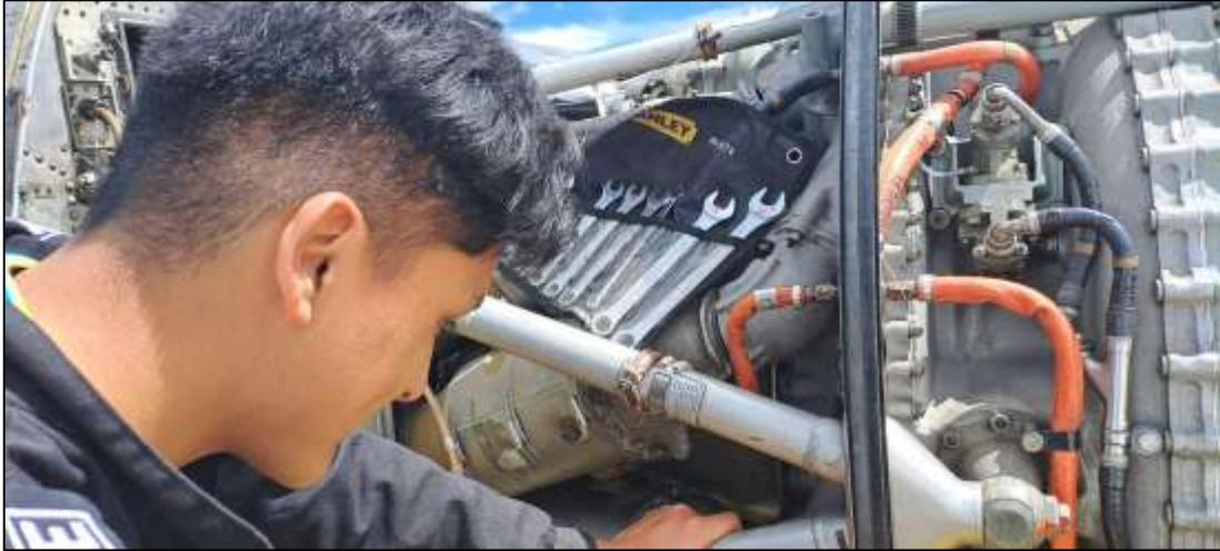
*Nota.* La imagen muestra la inspección de los montantes del motor.
