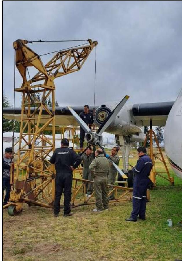
*Nota.* La imagen muestra el desacoplamiento y desmontaje de la hélice, con la utilización del tecele
