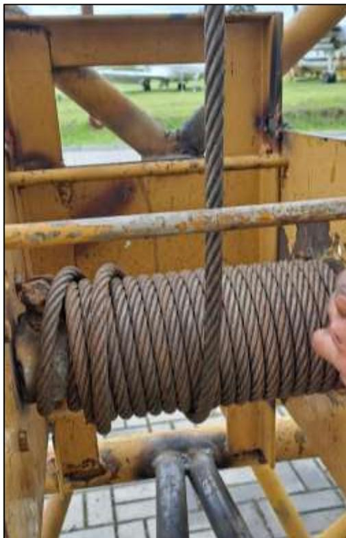
*Nota.* Puesta a punto el teclé, mediante el cambio de cable de izaje.
