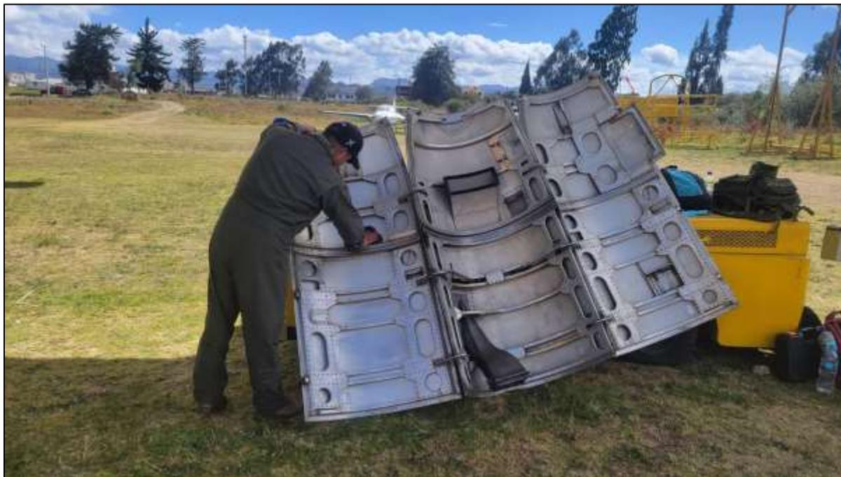
*Nota.* Cubiertas del motor Rolls Royce Dart ya removidas y desmontadas.
