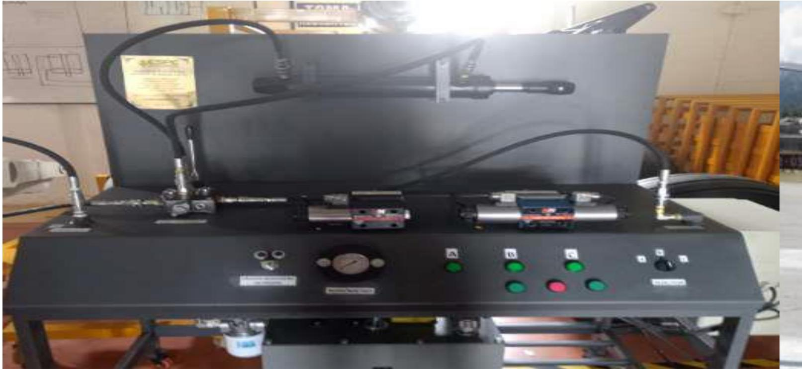
Se explicará cómo se realizó la inspección de 500 horas del actuador del accionamiento de los spoilers de la aeronave Hawker Siddeley HS 125, utilizando la información técnica. Para llevar a cabo esa tarea es necesario la remoción del actuador, para realizar las pruebas de accionamiento del mismo en el banco hidráulico.
