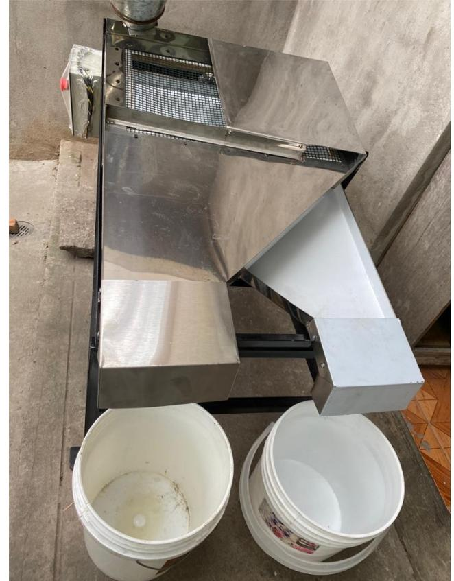
El diseño será de bandeja doble, que separará los dos tipos de granos a implementar en el sistema
