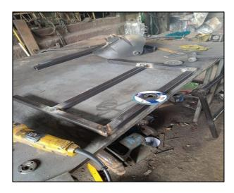
Nota. Suelda de los tubos con el tipo de soldadura MIG, se muestra el primer perfil que sostendrá la estructura.
