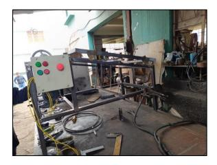
*Nota.* Se observa la estructura ya armada, verificada que todos los puntos de suelda estén reforzados para evitar inconvenientes futuros.
