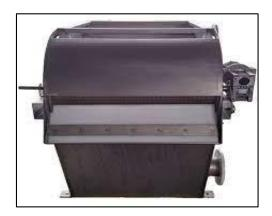
Nota. Se muestra un Tamiz Rotatorio-recíproco, que explica el funcionamiento de separación de componentes sólidos de líquidos. Tomado de (Ecofricalia, 2018)
