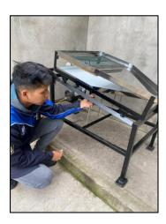
Nota. Se debe verificar antes de cada proceso, la ubicación de los rieles guías para el movimiento de la bandeja y revisión de los resortes.
