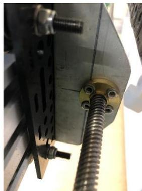
*Nota.* Base soporte tuerca tornillo sin fin fijado a las placas universales del eje X.
