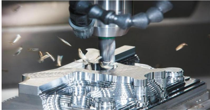
*Nota.* Fresadora CNC removiendo material. Tomado de (Viotto, 2022)
