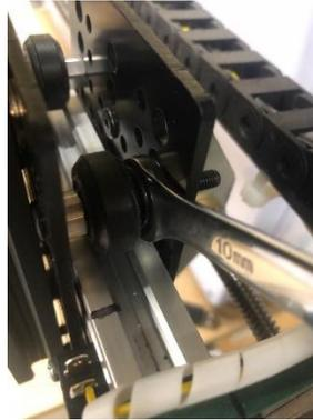
*Nota.* Ajuste de los espaciadores excéntricos para la fijación de las placas a los rieles.
