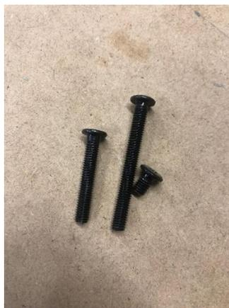
*Nota.* Tornillos M5 utilizados para la fijación de los elementos de la máquina.
