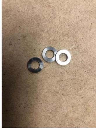
*Nota.* Arandelas de seguridad para tornillos M5.
