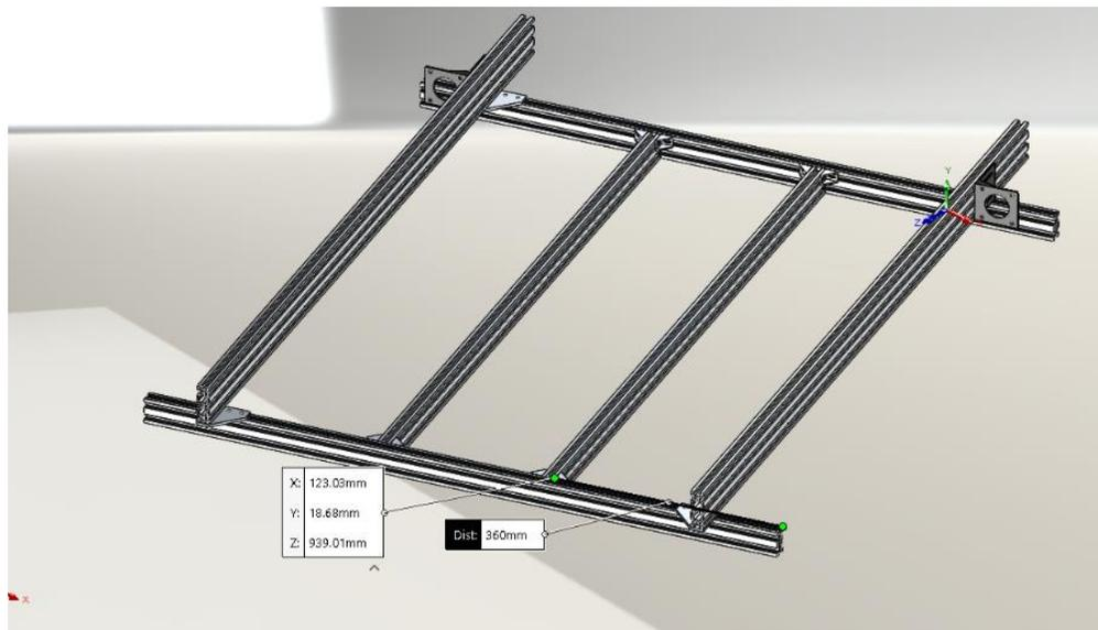
*Nota.* Distancia para fijar los perfiles de Aluminio tipo V 20 x 60 al chasis.
