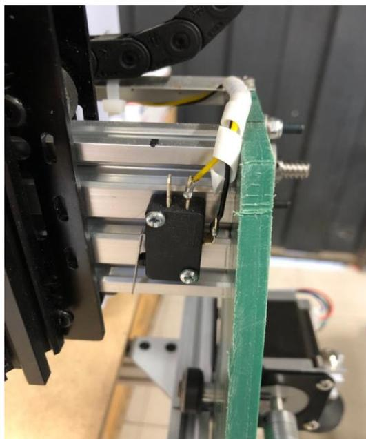
*Nota.* Finales de carrera fijados con tornillos M3 y tuercas M3.
