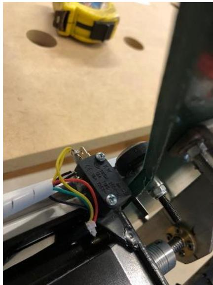
*Nota.* Finales de carrera fijados con tornillos M3 y tuercas M3.
