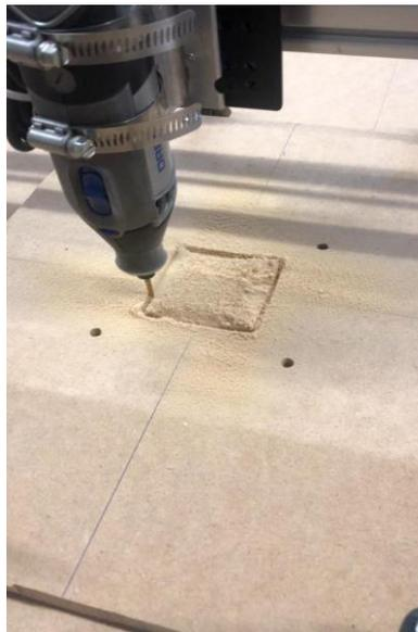
*Nota.* Planeado realizando en madera MDF de 18mm de grosor, con una profundidad de 1.5mm
