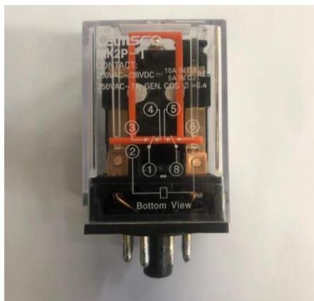
*Nota.* Conexiones Normalmente cerradas y abiertas para el relé.
