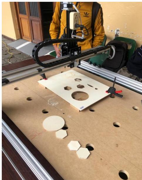
*Nota.* El material utilizado para el corte es Trípex de 4 mm de grosor.
