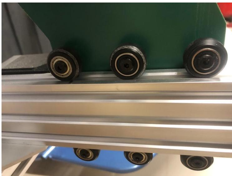
*Nota.* Placa lateral montado sobre el perfil de Aluminio.
