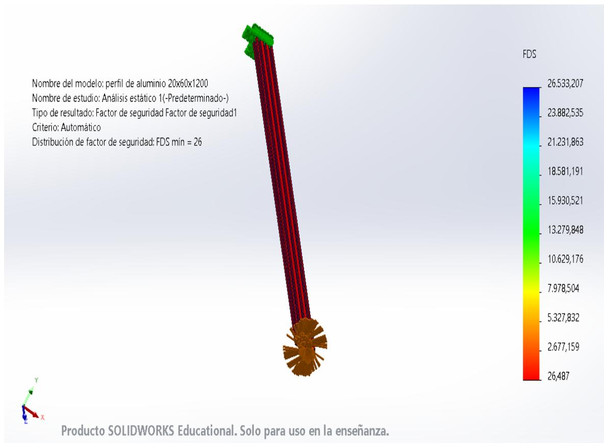
*Nota.* Factor de seguridad realizado en el software SolidWorks 2022.
