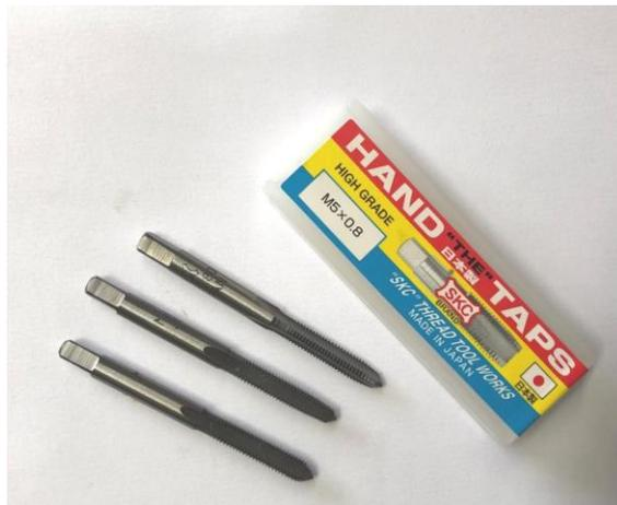
*Nota.* Machuelo M5x0.8 para el roscado de los perfiles de Aluminio tipo V.
