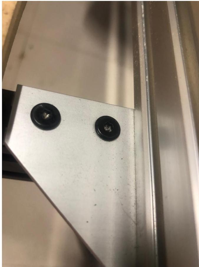
*Nota.* Placa de unión L Fijado Sobre el perfil inferior, perfil de aluminio tipo V 20x60 Fijado sobre la placa de unión L.
