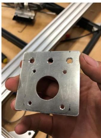
*Nota.* Base fijada por medio de tornillos M5x25mm.
