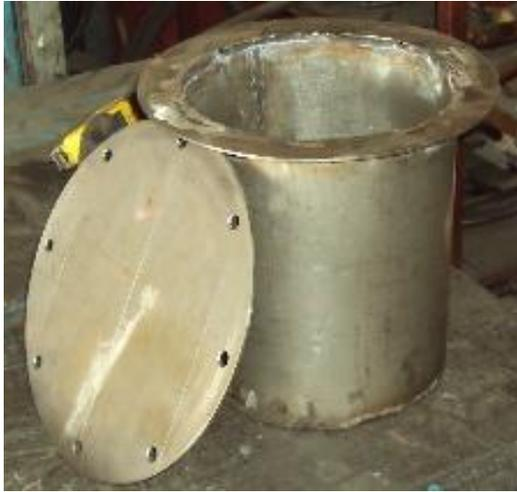
**Fotografía 5.7** Construcción del Recipiente Aromatizante
