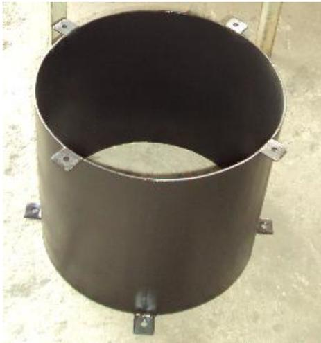
**Fotografía 5.6** Construcción de la Base del Absorbedor
