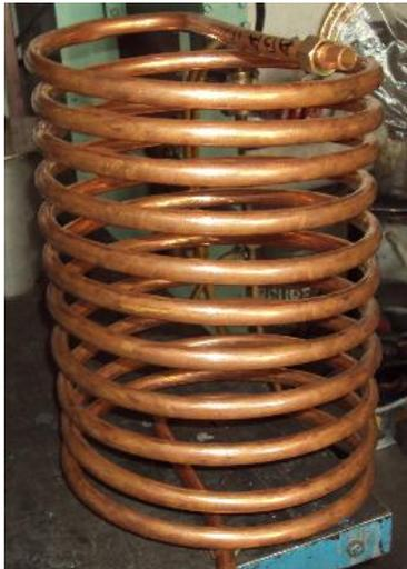
**Fotografía 5.4** Serpentina de Cobre (Intercambiador de calor)
