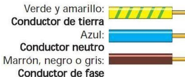
*Nota.* En la Ilustración se puede observar las diferencias de color de un cable conductor tomando de (areatecnologica,2019 )
