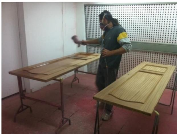
*Nota.* La ilustración muestra el proceso de laqueado de dos puertas tomando de (MQMuebles interiores, 2021)
