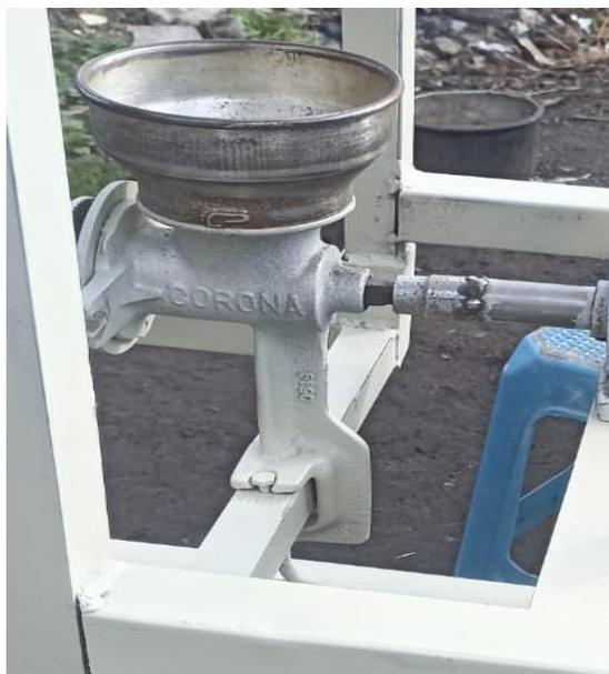
*Nota.* Realizamos el dimensionamiento y sujeción mediante pernos de dos chumaceras que van en la parte superior al frente del molino manual utilizamos dos llaves americanas número 14 y colocación de polea externa que transmite movimiento al eje del molino.
