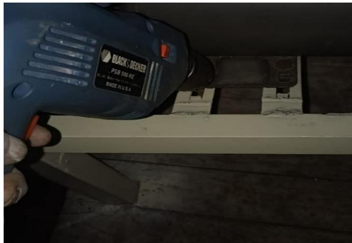
*Nota.* De la misma manera se realizó agujeros de 8mm donde va sujeta las chumaceras y el molino manual para el sistema de transmisión.
