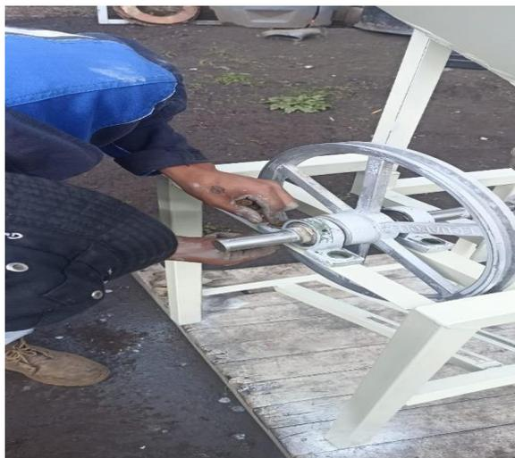
*Nota.* Una vez colocado las chumaceras colocamos el motor eléctrico en la estructura realizada para el montaje tomando en cuenta que no dañemos los pernos de sujeción.
