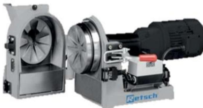
*Nota.* Ilustración de un molino de fricción. (VULCANOTEC, 2020)
