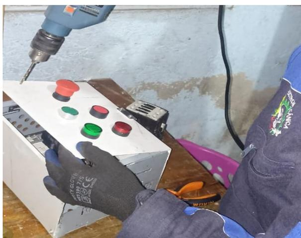
*Nota.* La fotografía muestra el montaje del tablero de control.
