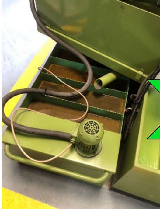
Contaminación del fluido soluble
