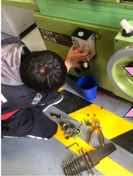
Fugas de fluido en la bomba de lubricación
