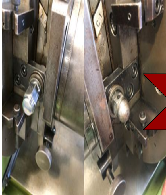
Irregularidad en los tornillos de regulación
