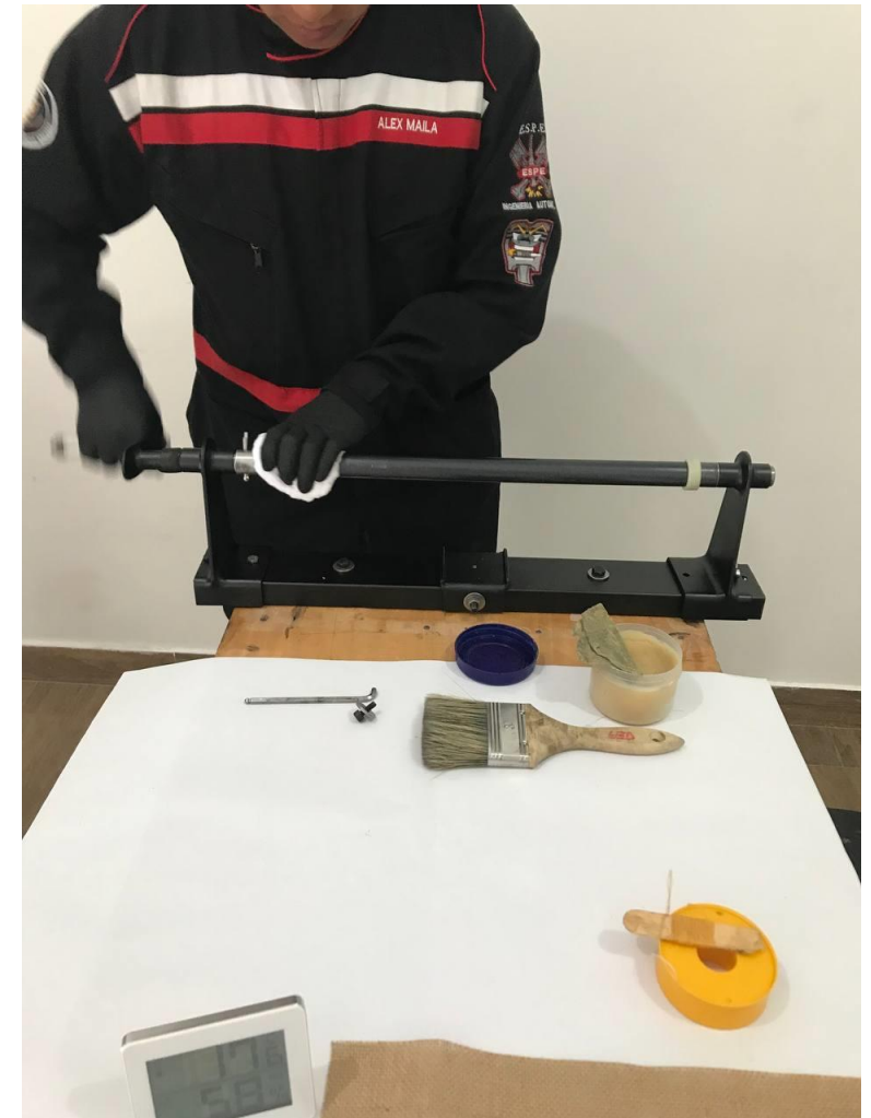
Encerado de la probeta matriz.
