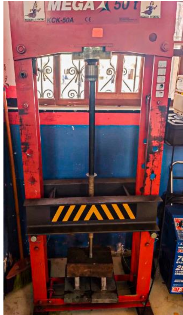
Desmolde de las probetas mediante prensa hidráulica.
