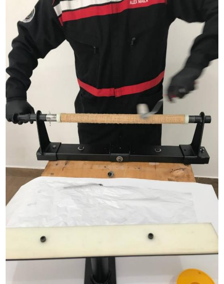
Colocación de la segunda capa de fibra de cabuya.
