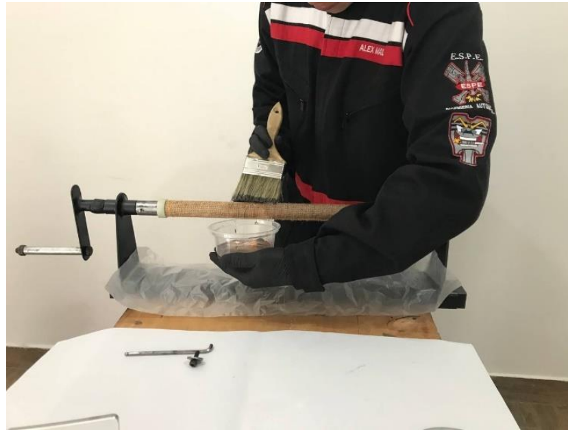
Colocación de la resina en la primera capa de fibra de cabuya.
