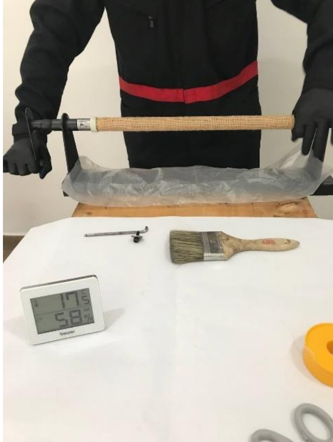
Posicionamiento de la primera capa de la fibra de cabuya al tubo matriz.
