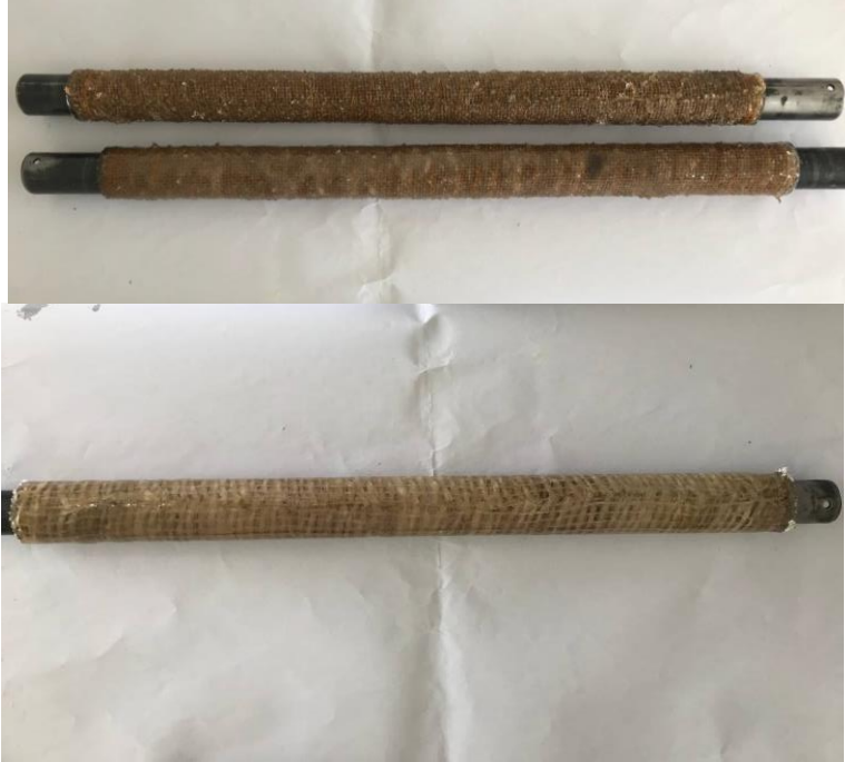
Secado y curado de las probetas reforzadas con fibra de cabuya.
