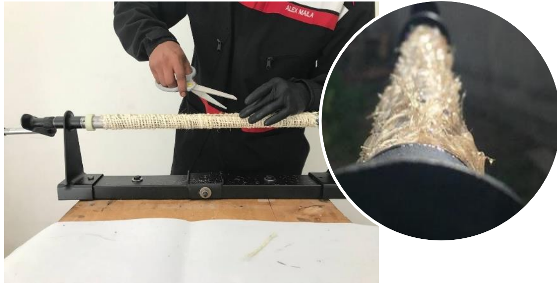
Proceso de limpieza de impurezas de la fibra.
