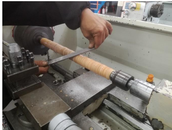
Acabado superficial de las estructuras tubulares
