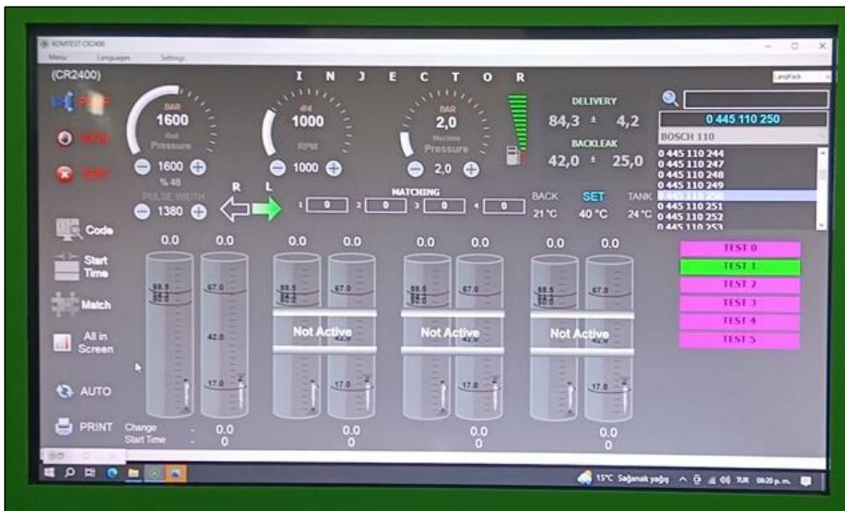
*Nota.* Pantalla principal donde se configura para las diferentes marcas de inyectores. (Cortesía de Full Diesel Valencia).
