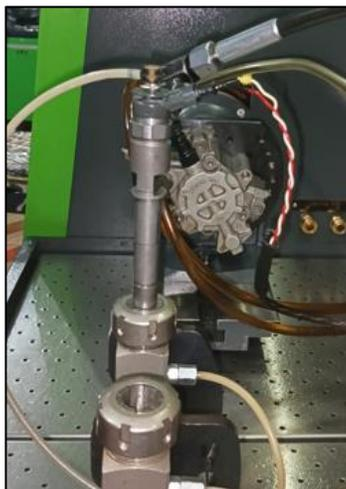
*Nota.* Verificación de la estanqueidad del inyector CRDI Bosch 0 445 110 293 en el banco de pruebas a 300 bar.
