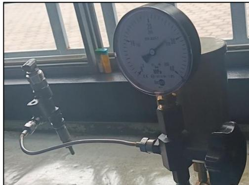
*Nota.* Verificación que no exista fugas por el retorno del inyector Bosch 0 445 110 293
