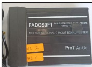
*Nota.* Osciloscopio FADOS 9F1 para diagnosticar y analizar por imágenes mediante diagramas equivalentes de los elementos electrónicos.
