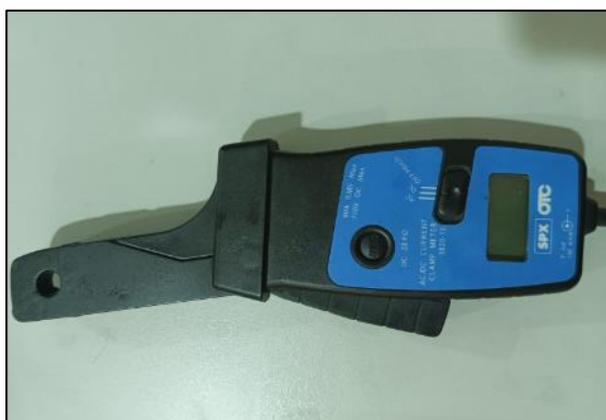
*Nota.* Se aprecia la pinza amperimétrica utilizada en nuestros inyectores Bosch.
