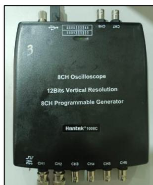
*Nota.* Se muestra el Osciloscopio Hantek utilizado para obtener las curvas de fase de activación de corriente, voltaje de los inyectores Bosch.
