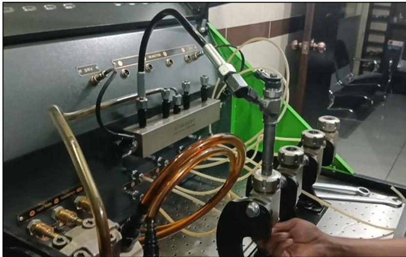
*Nota.* Se observa al inyector CRDI Bosch 0 445 110 250 conectado al banco de pruebas.
