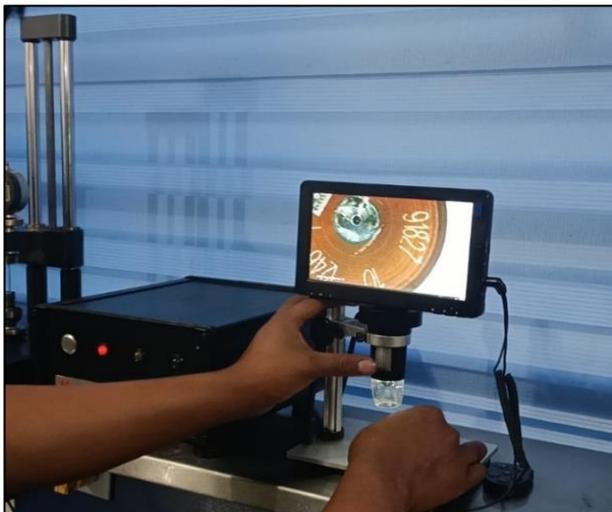
*Nota.* Verificación del estado de la válvula mediante el microscopio en el inyector Bosch 0 445 110 250.
