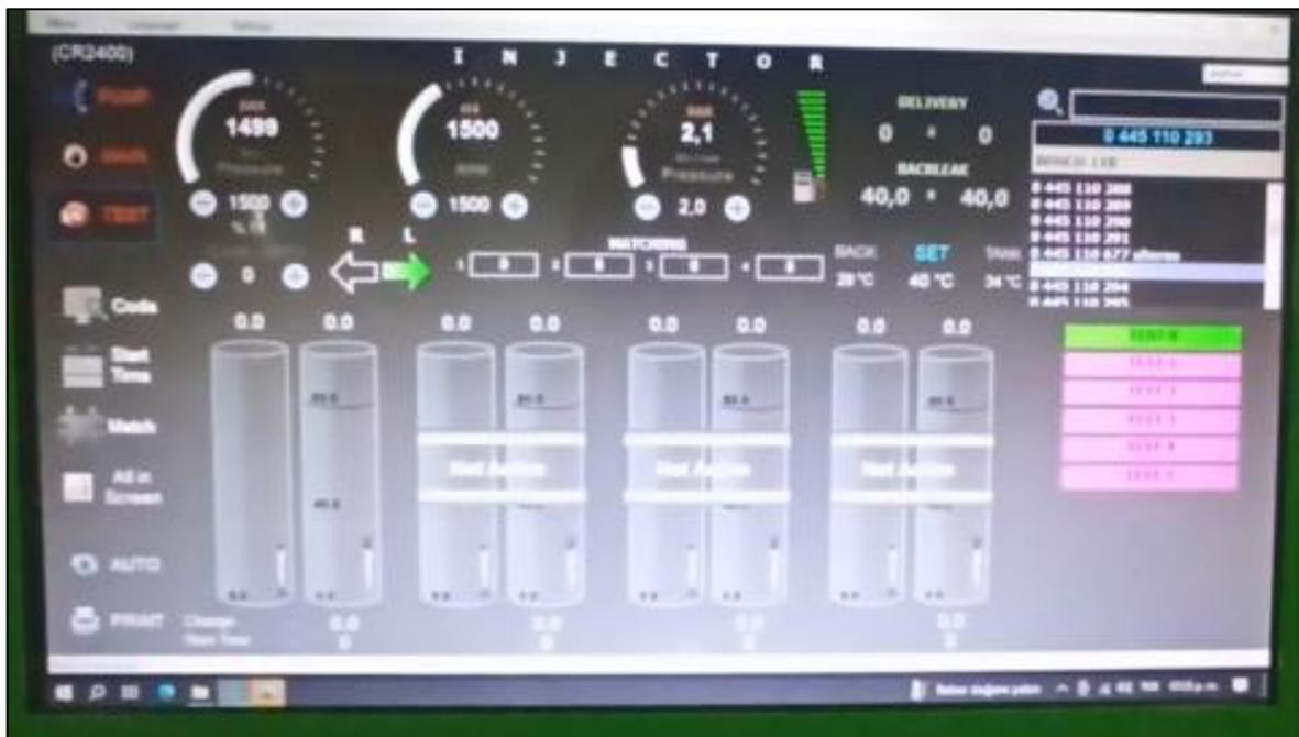
*Nota.* Configuración para las pruebas respectivas del inyector CRDI Bosch 0 445 110 293. (Cortesía de Full Diesel Valencia).
