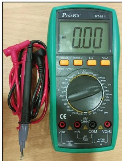
*Nota.* Se muestra el multímetro con el cual se realiza las pruebas de resistencia e inductancia en los inyectores.
