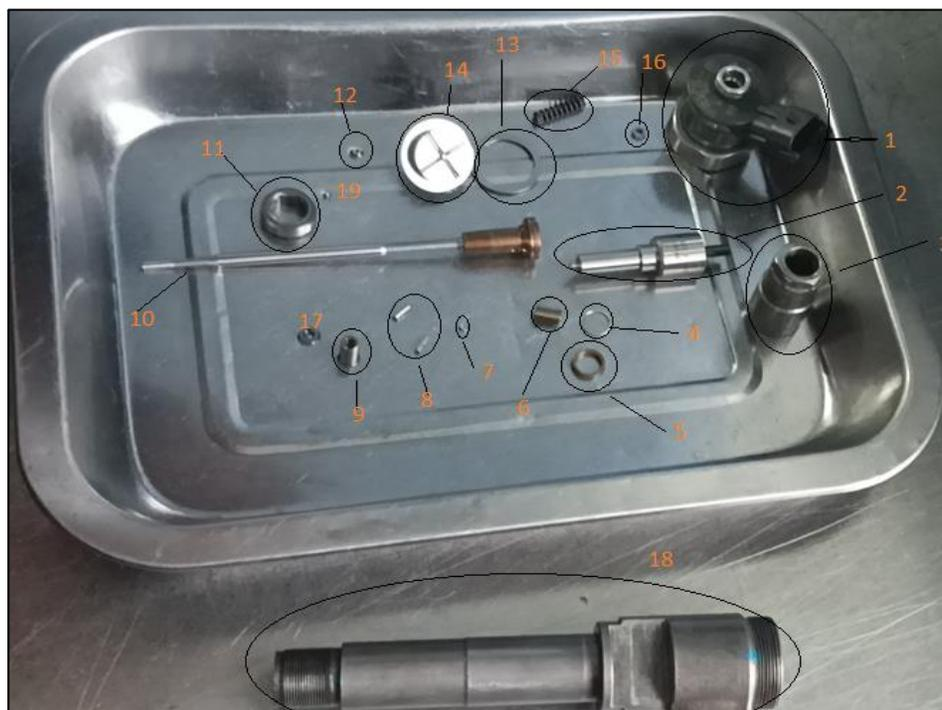
*Nota.* En la imagen se observa todo el despiece del inyector Bosch 0 445 110 250 para posteriormente continuar con la calibración y medición de los anillos de calibración.
