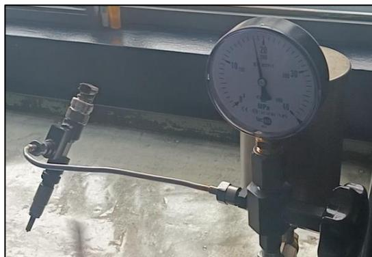
*Nota.* Verificación que no exista fugas por el retorno del inyector Bosch 0 445 110 250
