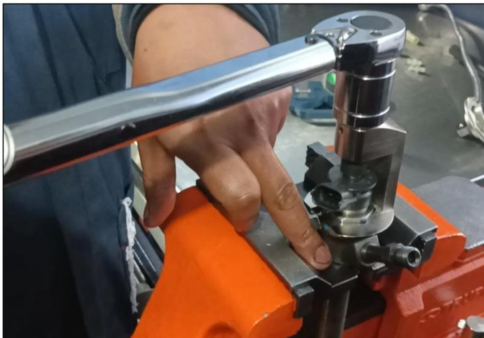
*Nota.* Aplicación del torque de ajuste necesario al inyector Bosch 0 445 110 250 y 0 445 110 293
