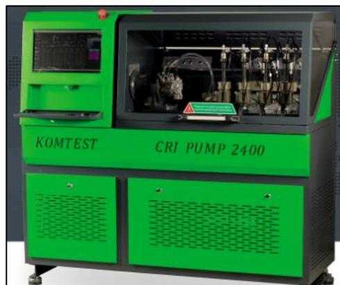
*Nota.* Banco de pruebas KOMTEST CRI PUMP – 2400 que realiza las distintas pruebas mecánicas y electrónicas del inyector. (KOMTEST, 2021)
