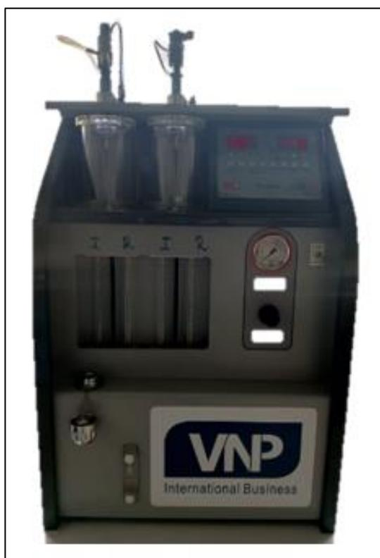
*Nota.* Banco Tester V-3500 VNP que realiza las distintas pruebas mecánicas y electrónicas del inyector.
