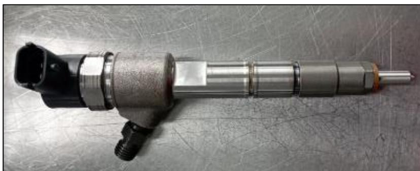
*Nota.* En la imagen se puede apreciar las características del inyector Bosch serie 0 445 110 293.
