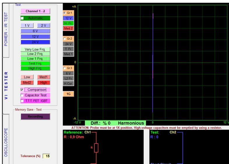
Nota. Gráfica de la resistencia del inyector Bosch 0445 110 250 y 0445 110 293
