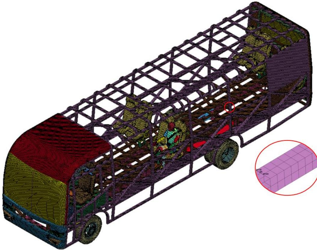
Sección 50x50 mm se utilizará un tamaño de malla de 25 mm.
