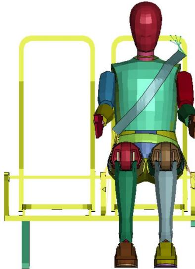
*Nota.* Se presenta la configuración del cinturón de seguridad de tres puntos en el minibús sin ninguna interferencia en el Maniquí Híbrido III percentil 50.
