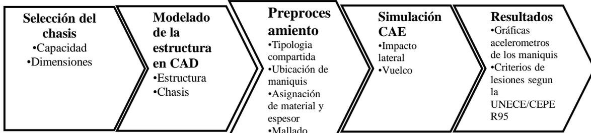
*Nota.* La figura siguiente muestra el proceso para modelar y simular el impacto lateral y vuelco, analizando cómo se ve afectada la seguridad de los ocupantes en un minibús. Combinando software CAD y CAE, obtenemos resultados detallados que revelan la afectación en diferentes escenarios de manera integral.
