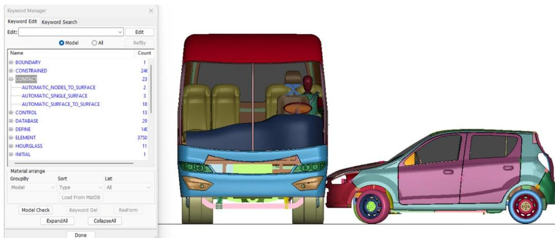
*Nota.* La imagen representa la adherencia entre el bus, el vehículo y el suelo y los contactos entre el maniquí y el cinturón de seguridad
