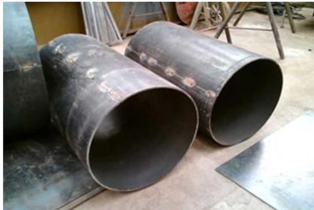
*Nota.* En la figura 2 se observa el proceso de rolado en forma cilíndrica. Tomado de (CORPORACION AYALA SAC, 2017)
