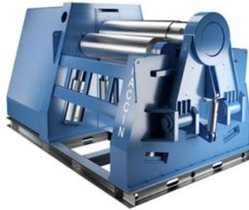
*Nota.* En la figura 7 se tiene una máquina roladora de 4 rodillos, el cual nos indica el proceso de rolado. Tomado de (FACCIN S.P.A, 2022)
