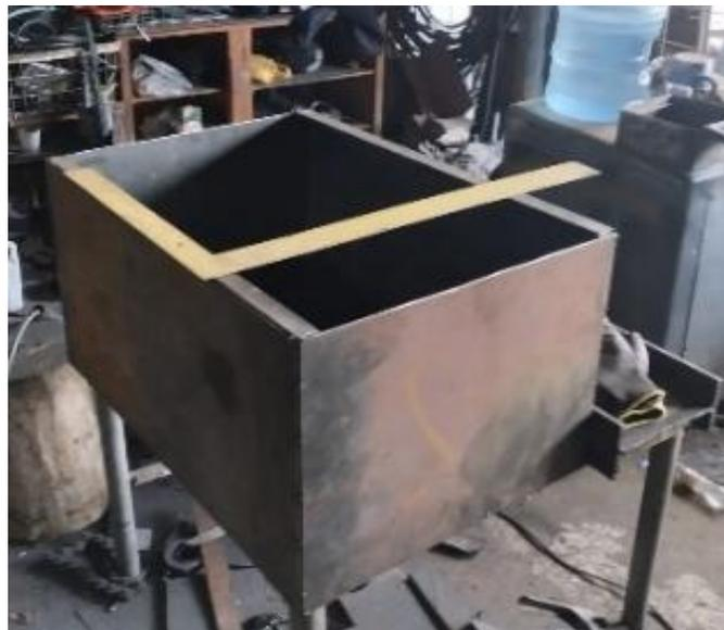
*Nota.* En la figura 53 se tiene la construcción del depósito del sistema hidráulico.
