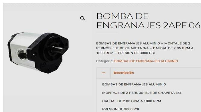
*Nota.* En la figura 54 se observa la bomba que se instalará en el circuito hidráulico. Tomado de (HIDRONEUMATIC, 2013)
