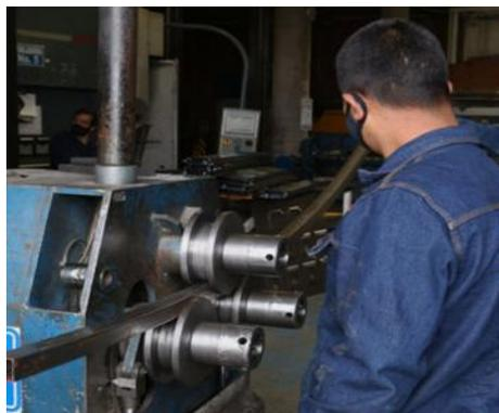
*Nota.* En la figura 4 se puede observar el proceso de rolado de perfiles mediante una máquina roladora de tres rodillos. Tomado de (Dobladora Carvajal, 2019)
