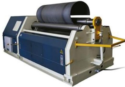
*Nota.* En la figura 3 se puede observar el proceso de rolado de una chapa metálica plana donde se le da una geometría cilíndrica. Tomado de (FEYSAMA, 2019)
