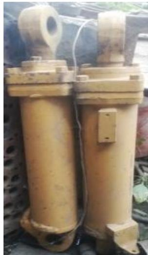
*Nota.* En la figura 20 indica un cilindro hidráulico doble efecto que sirven para realizar trabajos lineales.
