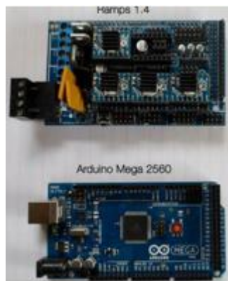
Tarjeta Arduino Mega y Tarjeta Ramps 1.4
