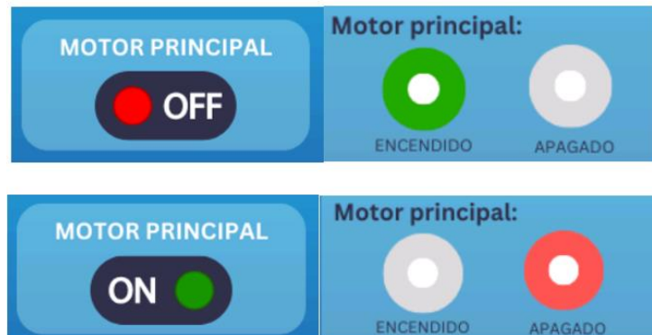
Funcionamiento de panel de estado del motor principal
