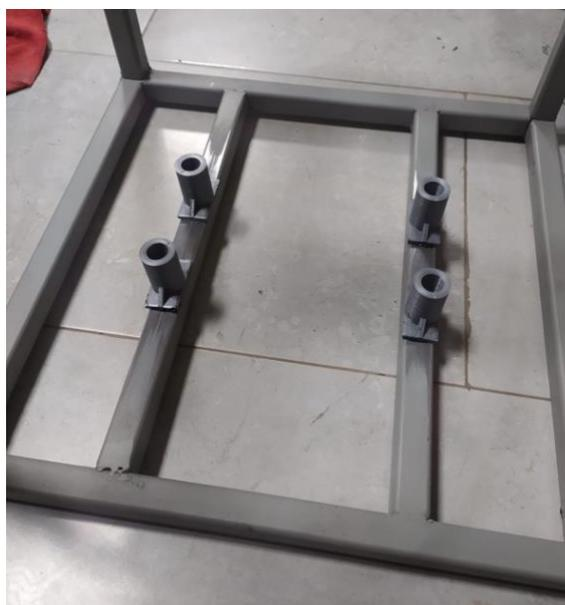
Procedemos ya a unir las partes anteriormente montadas, para poder realizar el ensamble con el uso de los resortes y de la superficie de desgaste, cuando el pie presione hacia abajo la superficie de desgaste también se desplaza una mínima cantidad por medio de los resortes, lo que nos permite que se genere una fuerza que nos ayuda a simular el peso de una persona de estatura normal.
