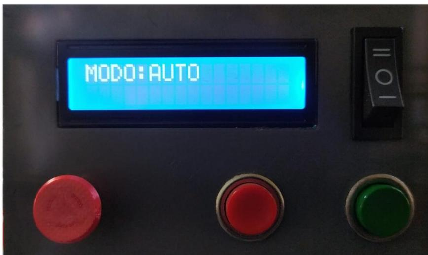
En el modo automatico los pasos son continuos, se puede visualizar el estado en la esquina inferior izquierda, el indicador EJEC, se interpreta como ejecutando. Mediante el pulsador Inicio ubicado en el panel en la esquina inferior izquierda, como un botón de color se iniciará el modo automático continuo. El botón de color rojo al costado derecho del panel es el
