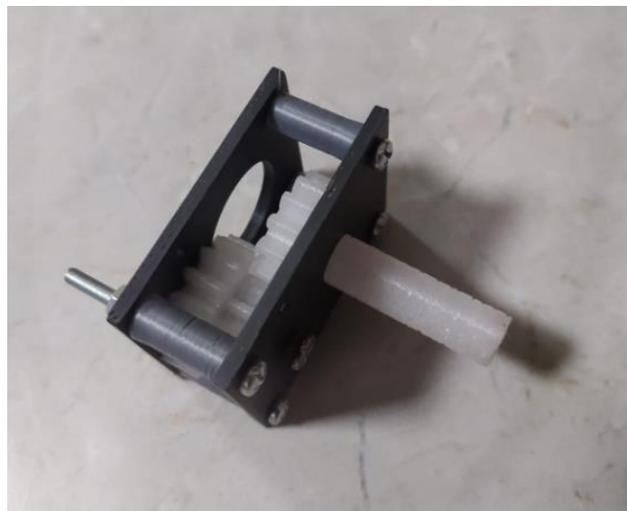
Para la construcción del prototipo de la máquina también se utilizó, piezas realizadas mediante impresión 3D, esto con la finalidad de poder obtener componentes que se ajusten de mejor manera a los requerimientos de nuestro diseño, además que este tipo de piezas no se las puede encontrar en el mercado.
