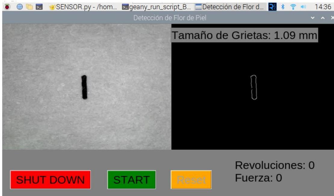
El ajuste de factor de escala se ha realizado usando una línea de 1 mm impresa sobre una hoja y colocada como muestra, de tal forma que el sistema corrobore su medida.
