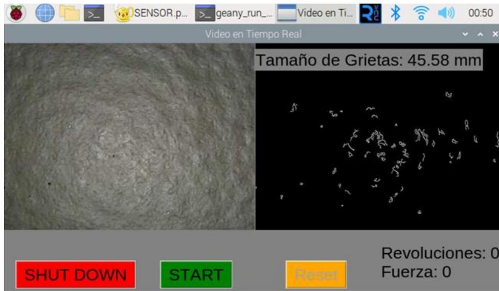
Como se puede observar en la imagen, el programa está detectando grietas y marca el tamaño total, pero estos no son las grietas reales, así que necesita un ajuste de los parámetros *threshold1* y *threshold2* y ajustes en el enfoque de la cámara para un correcto funcionamiento. Los ajustes finales se detallarán en la fase de pruebas.
