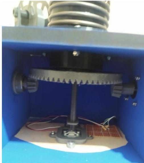
Luego, los componentes externos se colocan verificando que exista el espacio necesario para la conexión de los cables del sensor y los cables del motor.
