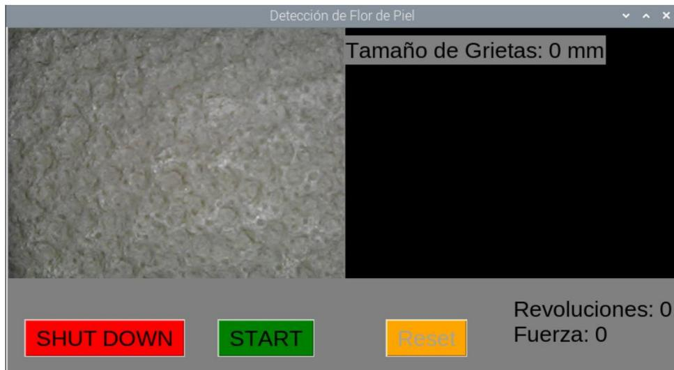
Con estos valores, la detección queda configurada correctamente en la posición de reposo de la probeta, de modo que el programa permitirá iniciar la prueba.
