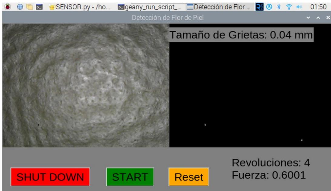
En este punto, la detección es mucho más precisa al detectar grietas cercanas o inferiores a 0.1 mm. Manteniendo esta calibración se han realizado pruebas del porcentaje de detección y pruebas de duración del ensayo.
