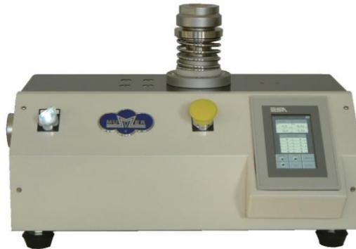
*Nota.* En la figura 16 se visualiza el modelo de un elastrómetro con software para comunicación con PC. Tomado de *Elastómetro electrónico Mod.5077-E* por (Muever, s.f.)
