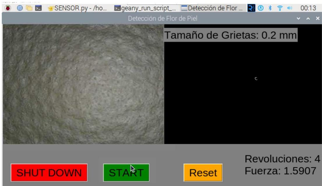
El sistema detecta con gran facilidad, finalmente se requiere ajustar el factor de escala para detener el ensayo cuando las grietas sean de una longitud mayor a 0.1 mm o la fuerza aplicada supere los 10 N.
