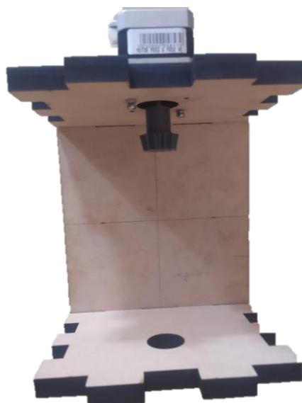
Una vez armada la estructura, se colocan los elementos que van al interior del Elastómetro (sistema de engranajes y sensor de fuerza junto con su circuito de acondicionamiento).
