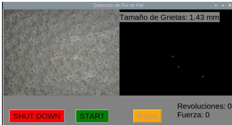
Como se observa en la figura 79, la detección ha mejorado en gran medida, pese a ello, no es suficiente dato que aun detecta el patrón rugoso del cuero como si fuera un defecto. Continuamos variando el ajuste de umbral: ***threshold1= 150 y threshold2=225***
