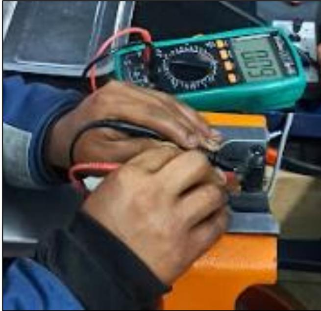
Medición de la capacitancia del inyector
