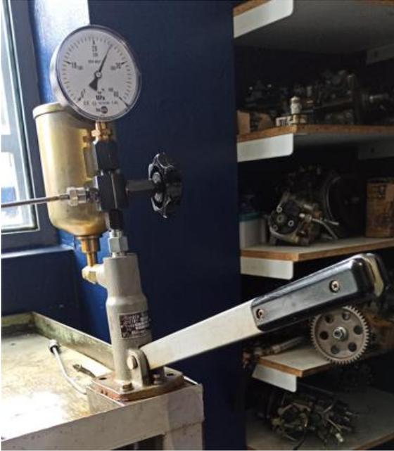
La presión de apertura del inyector para combustible oscila entre 140 y 150 bar. Si se somete a una presión menor, el inyector no se abrirá y no llevará a cabo la inyección del combustible.
