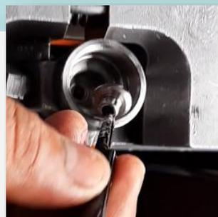
7) Desmontaje de los componentes internos en la cámara de control.
