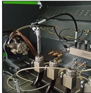
4) Verificación del ajuste del actuador (40-60) Nm.
