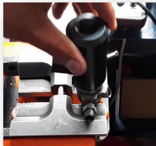
2) Desmontaje del actuador piezoeléctrico.
