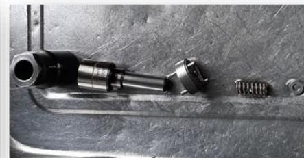
4) Extracción de elementos internos en el cuerpo del inyector
