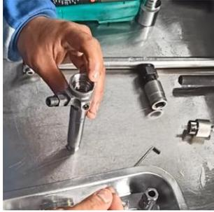
1) Colocación de arandela de compensación.
