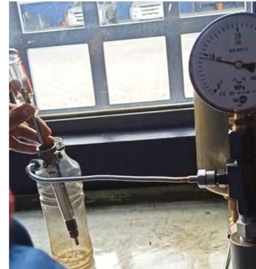
Se realizó una prueba de pulverización y se confirmó su correcto funcionamiento.
