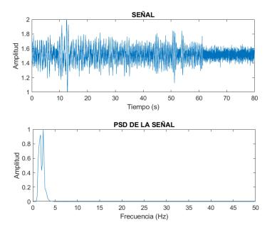
Nota. La Figura representa un evento microsísmico Tremor del Volcán Llaima localizado en Chile. El evento sísmico fue extraído de la base de datos sísmicos del Observatorio OVDAS. Se visualiza su comportamiento en tiempo y en frecuencia.
