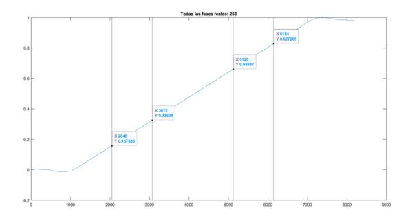
*Nota.* A partir del conjunto de fases con mayor concentración pertenecientes al evento TR, se obtiene una pendiente linealizada. De esta pendiente se extraen cuatro puntos clave ubicados en los puntos 3M/8, 5M/8, M/4 y 3M/4. Donde M representa los 8192 puntos de la transformada de Fourier.
