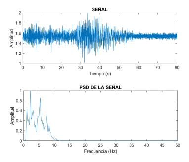
Nota. La Figura representa un evento microsísmico Tectónico del Volcán Llaima localizado en Chile. El evento sísmico fue extraído de la base de datos sísmicos del Observatorio OVDAS. Se visualiza su comportamiento en tiempo y en frecuencia.
