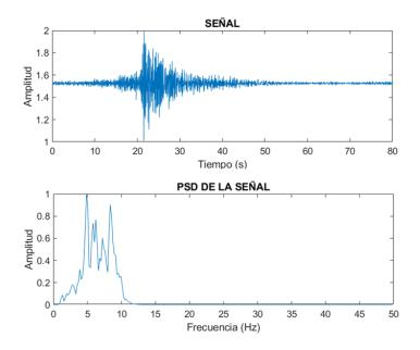
Nota. La Figura muestra una señal sintética tipo VT obtenida. Este evento está relacionado con las fallas frágiles de las rocas dentro del complejo volcánico. Presentó una duración mínima con amplio contenido espectral entre [0,1 - 10] Hz.
