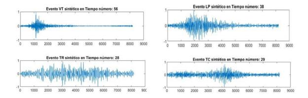
Nota. La Figura ilustra el proceso de recuperación del desfase en las señales sintéticas mediante la aplicación de la técnica de desplazamiento basada en la media.
