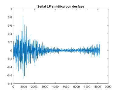
*Nota.* En la Figura, es evidente la presencia de un desfase en los puntos finales de la señal sintética. Esta característica surge debido a la variabilidad inherente a la fase ideal elegida.
