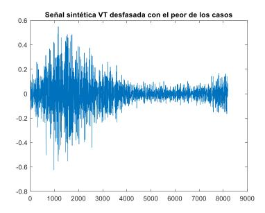
Nota. La Figura revela que la recuperación del desfase no se ha logrado de manera exitosa. Este resultado se origina en la consideración del caso extremo en el que se eligen las fases en los límites de sus rangos posibles.
