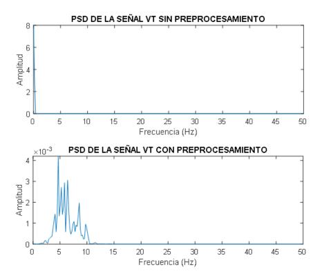
Nota. La Figura revela la presencia de un pico en 0.2 Hz que es tan marcado que prácticamente reduce la señal microsísmica a una magnitud despreciable.
