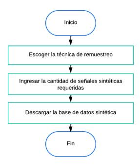
Nota. La Figura ilustra el diagrama de flujo del proceso de utilización de la aplicación para generar las señales sintéticas de los cuatro eventos microsísmicos.
