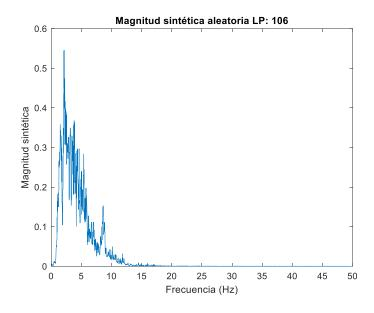
Nota. Magnitud sintética de una señal microsísmica LP antes de aplicar el sistema de espejo. Solo se representan sus primeros 4096 puntos.
