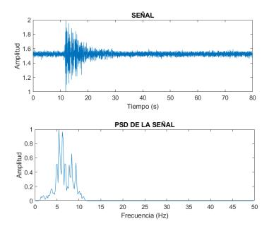
Nota. La Figura 3 representa un evento microsísmico Volcano Tectónico del Volcán Llaima. El evento microsísmico fue extraído de la base de datos sísmicos del Observatorio OVDAS. Se observa su comportamiento en tiempo y en frecuencia mediante la PSD.
