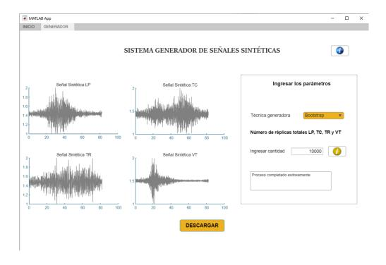
Nota. La Figura muestra la interfaz del generador de señales sintéticas. En el lado derecho, se introducen los parámetros requeridos, mientras que en la parte izquierda se visualizan las señales sintéticas asociadas a cada evento microsísmico.
