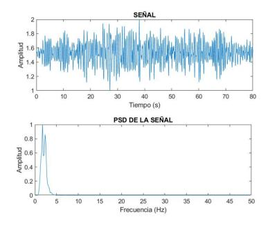
Nota. La Figura muestra una señal sintética tipo TR obtenida. Es un evento de gran amplitud generalmente producido por el movimiento del flujo de magma a través de las grietas en
