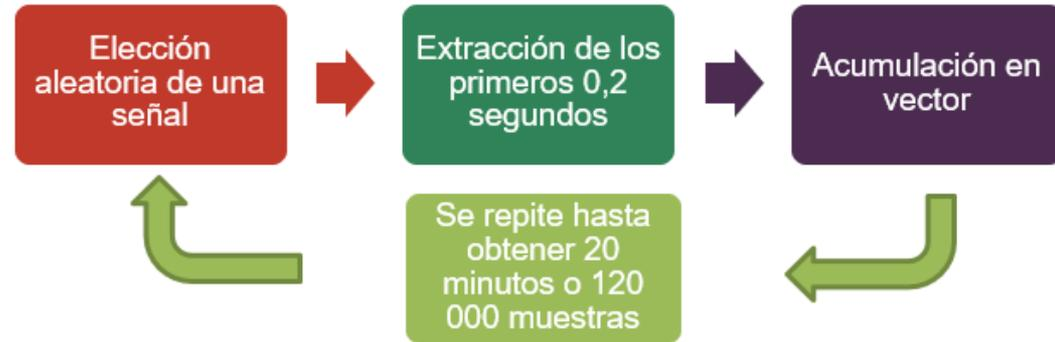
Fig. 7 Diagrama de bloques para la generación de señal de ruido
