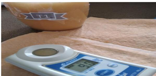
Nota. Manejo del refractómetro y pipeta para obtención de los °Brix en porcentaje, de la muestra. Autoría propia.
