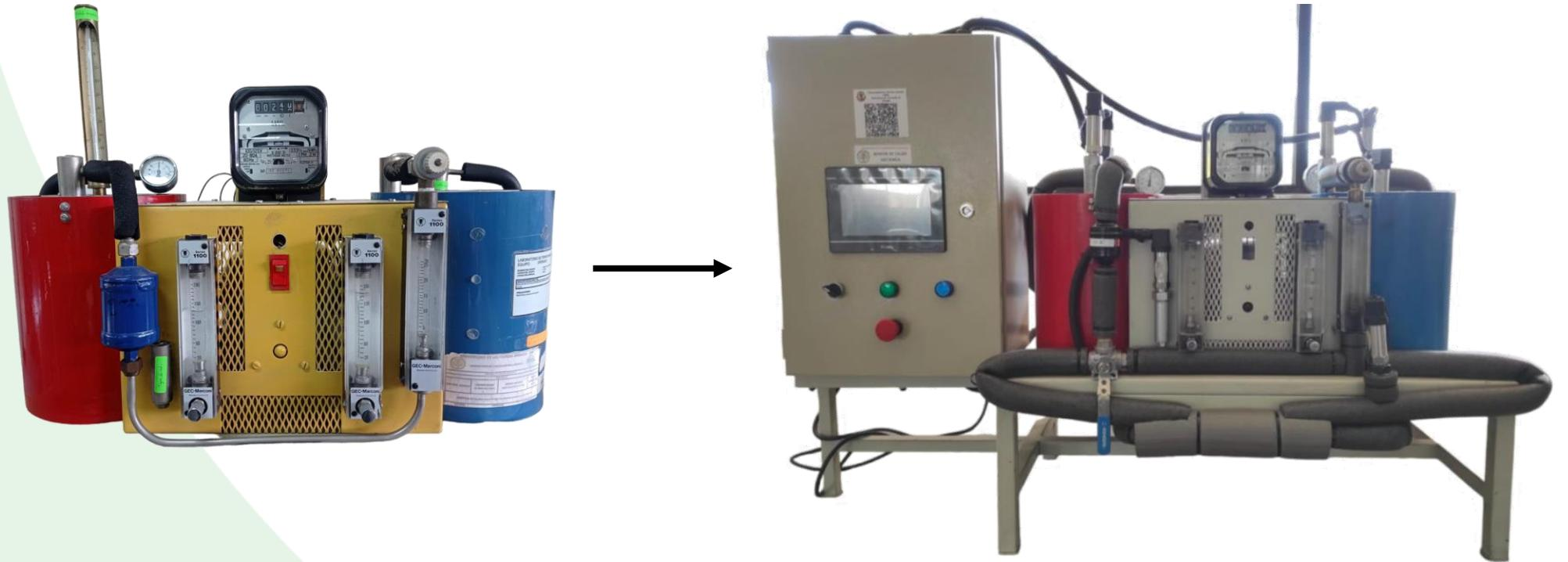
**Figura 54.** Repotenciación del Equipo Bomba de Calor Mecánica
