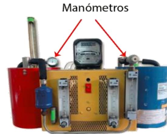
**Figura 6.** Manómetros de evaporador y condensador
