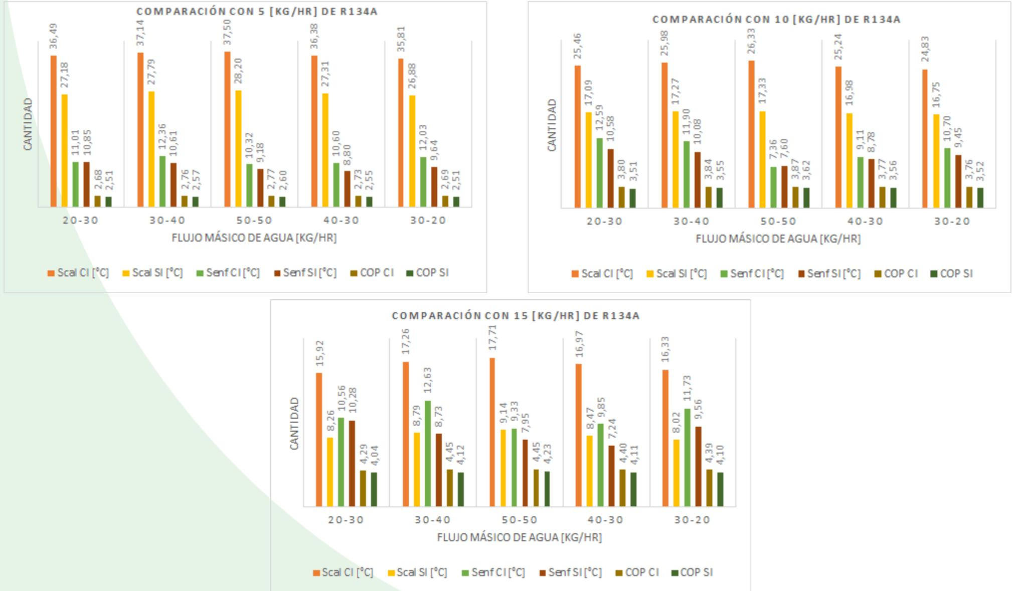
Figura 51. Comparación de sobrecalentamiento total, subenfriamiento total y COP
