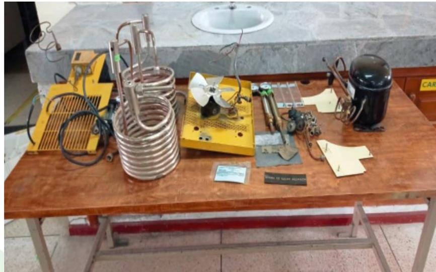
**Figura 9.** Limpieza superficial de todos los componentes
