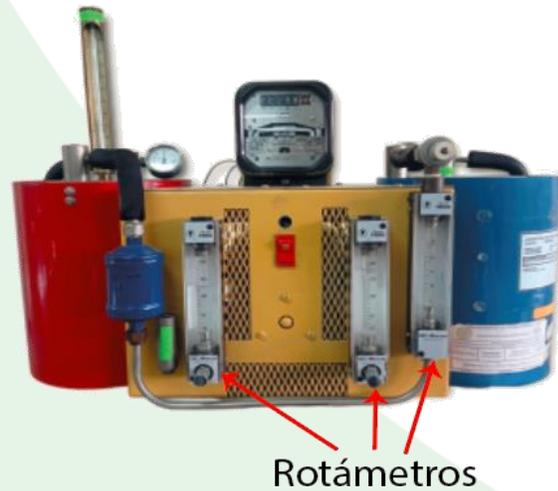
**Figura 5.** Rotámetros de agua y refrigerante
