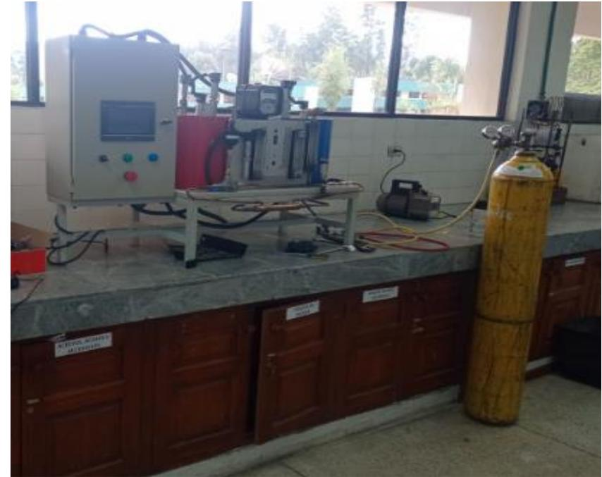
**Figura 33.** Vacío, presurización y carga del sistema
