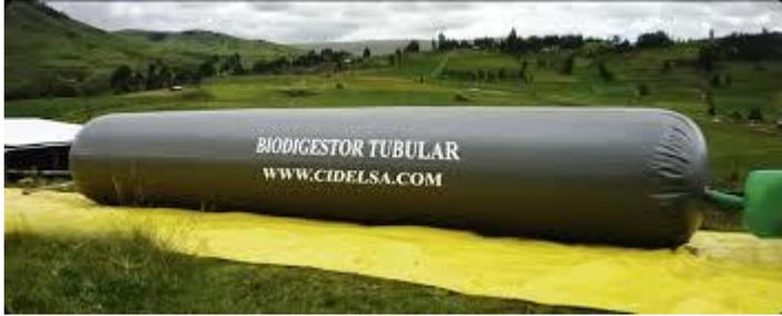
Digestores tubulares fabricados en polietileno
