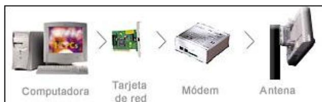
Figura 2. 30 Funcionamiento básico de un sistema microonda
