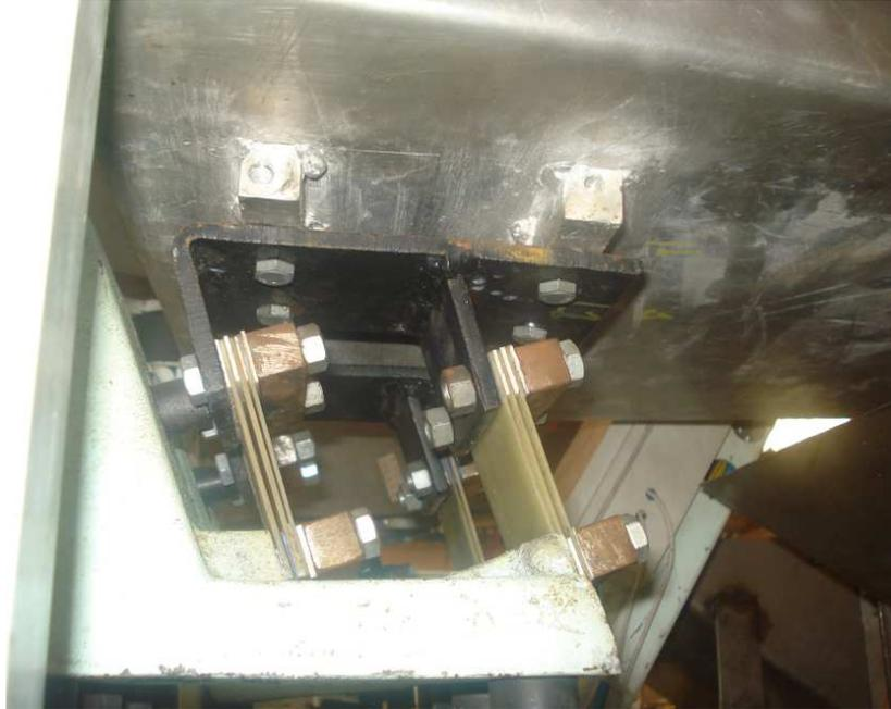
Fig. 4.55. Vibrador armado
