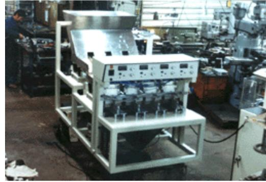
Fig. 2.3. Empacadora horizontal de granos, sistema fiable de celdas de carga<sup>2</sup>
