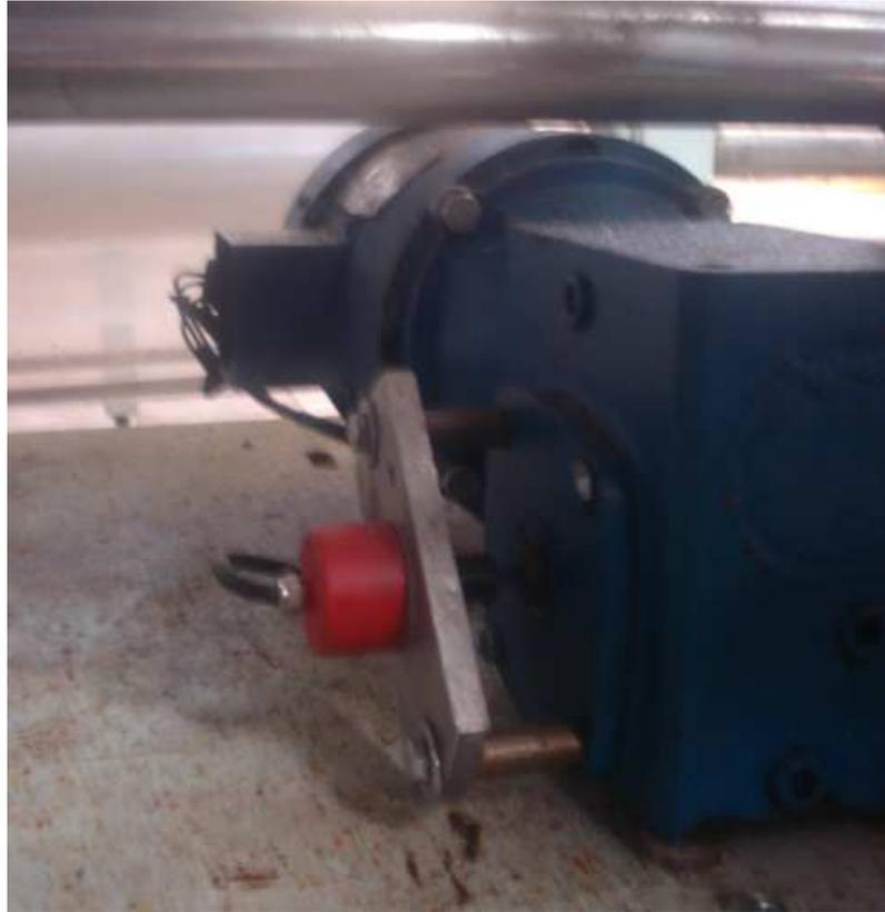
Fig. 4.75. Caja reductora con encoder
