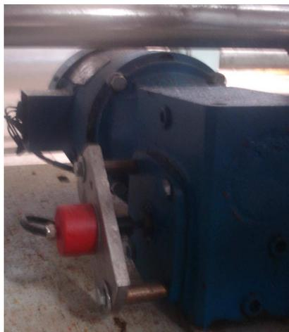
Fig. 5.18. Ubicación del encoder en la caja de reducción.
