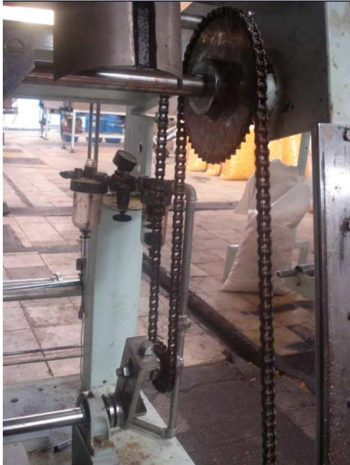
Fig. 4.70. Sistema motriz eje, brazo, catalina, cadena
