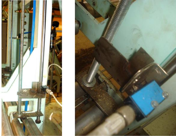
Fig. 5.14. Ubicación del sensor de la marca.
