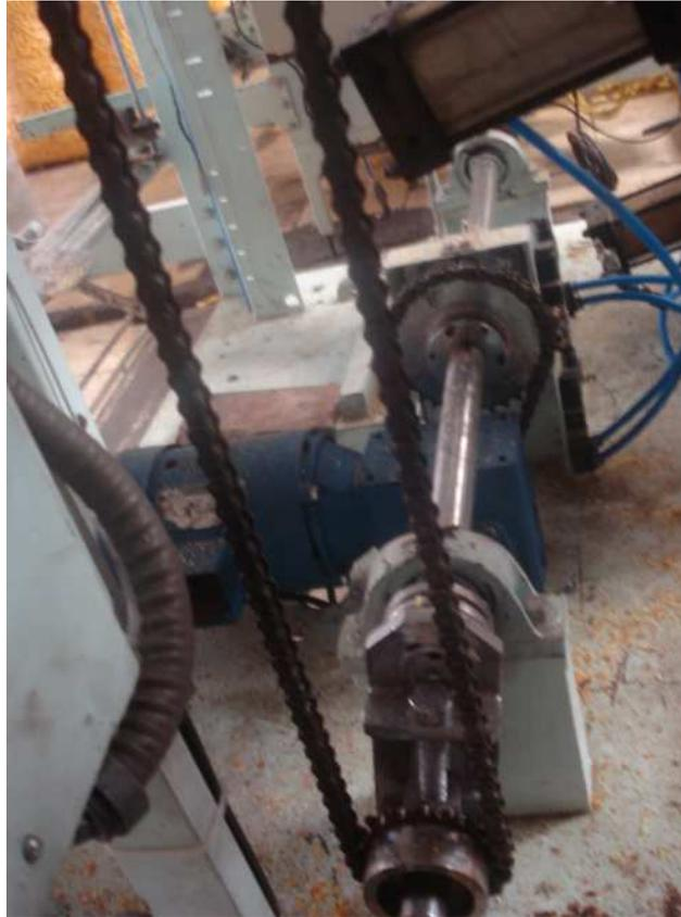
Fig. 4.72. Sistema motriz eje, brazo, cadena, motor, caja reductora
