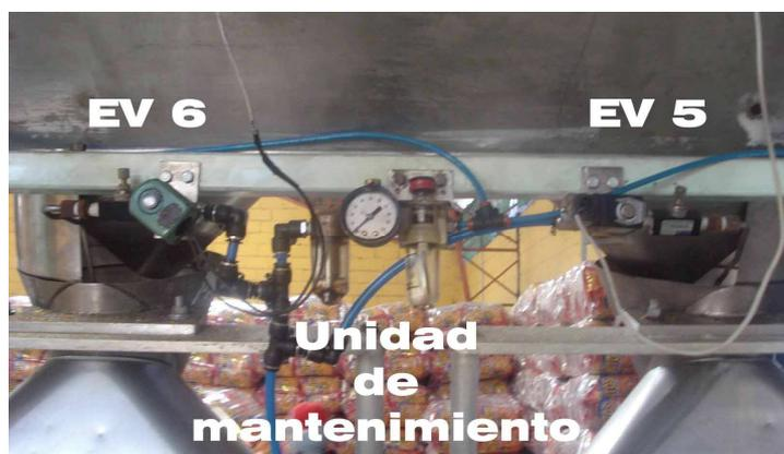
Fig. 5.20. Ubicación de las válvulas solenoide
