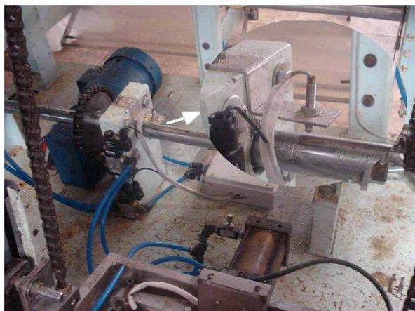
Fig. 5.13. Ubicación del sensor inductivo de proximidad.
