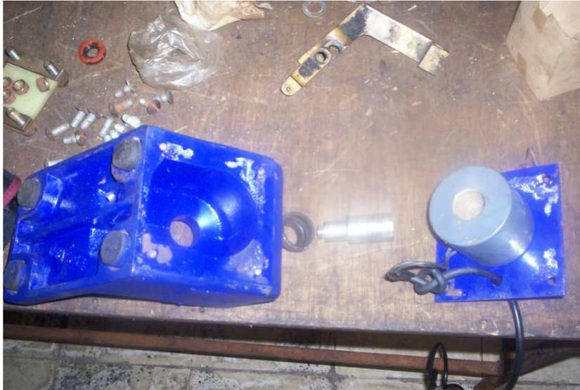
Fig. 4.54. Vibrador antes de ensamblar
