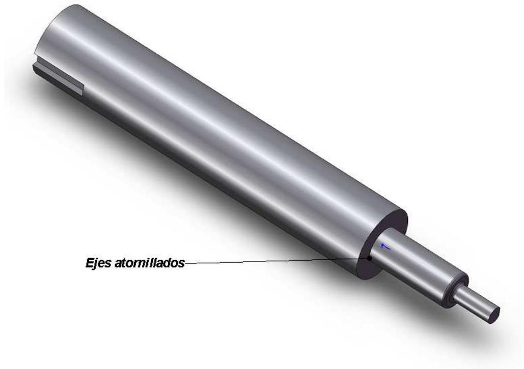
Fig. 4.73. Ejes atornillados del eje de salida de la caja reductora
