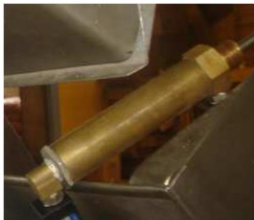
Fig. 4.68. Cilindro para la apertura de la bandeja de pesaje
