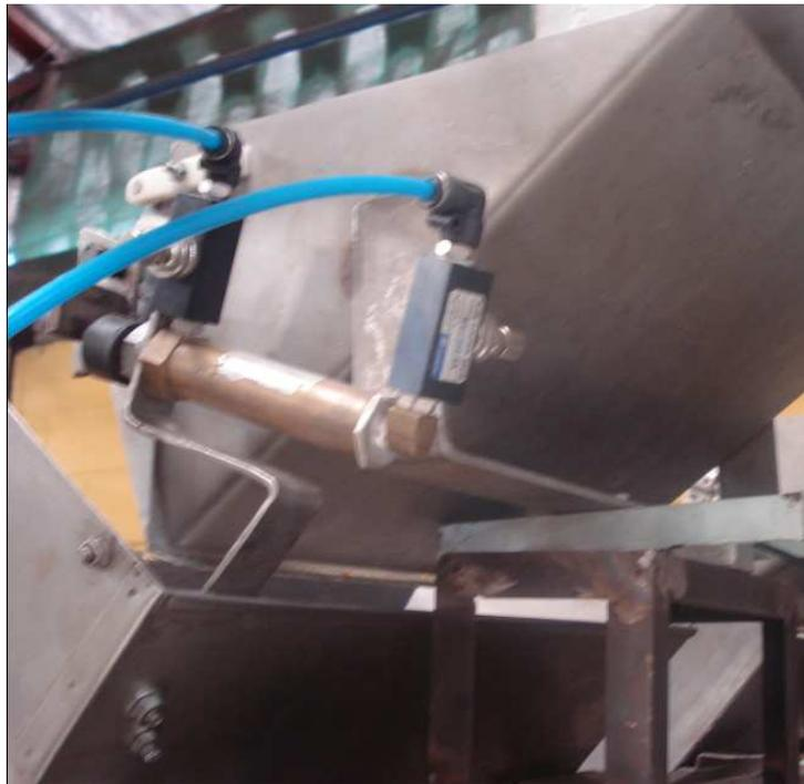
Fig. 5.19. Ubicación y soportes para cilindros de apertura de compuerta
