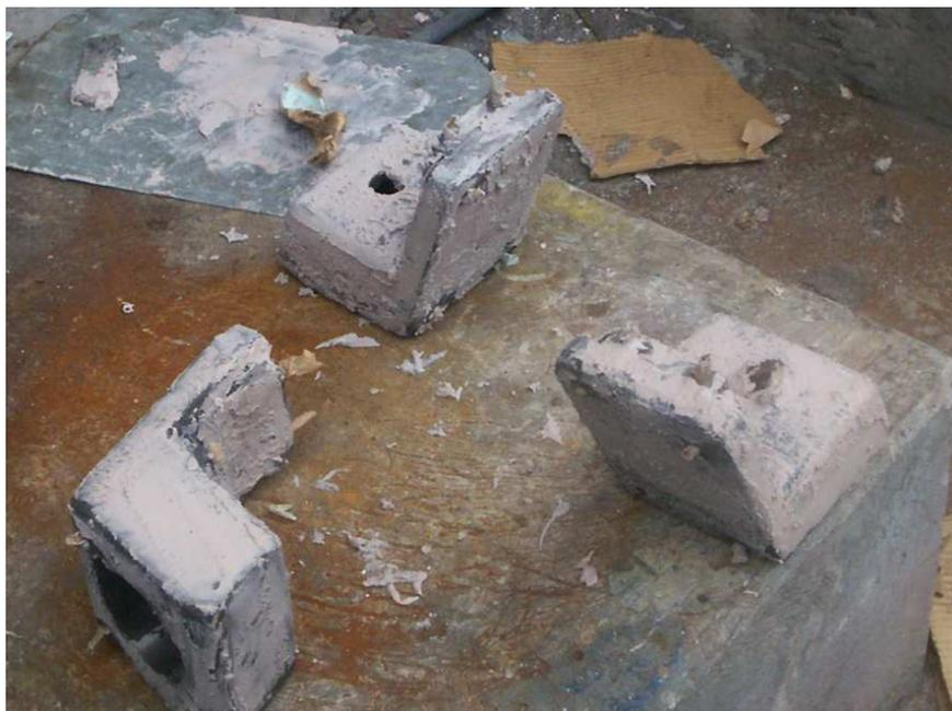
Fig. 4.53. Fundición de vibradores masilladas.
