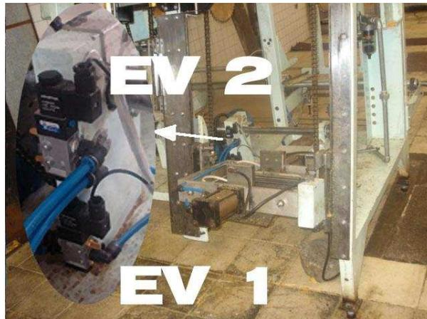
Fig. 5.21. Ubicación de electro válvulas
