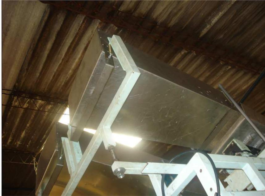
Fig. 4.48. Bandejas y vibradores
