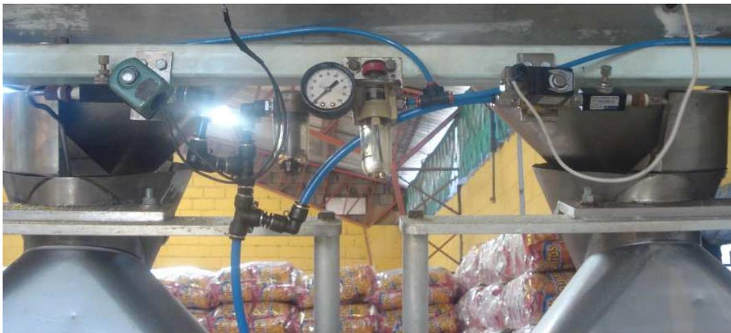
Fig. 4.64. Conjunto de válvulas solenoides para soplar aire en las fundas
