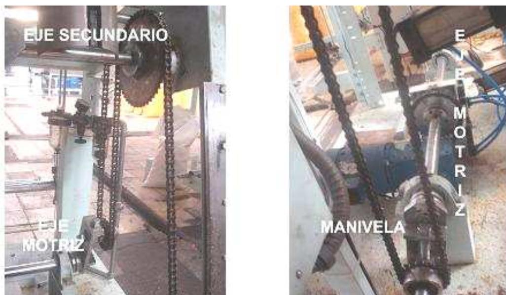
Fig. 2.12 Mecanismo de empaquetadora
