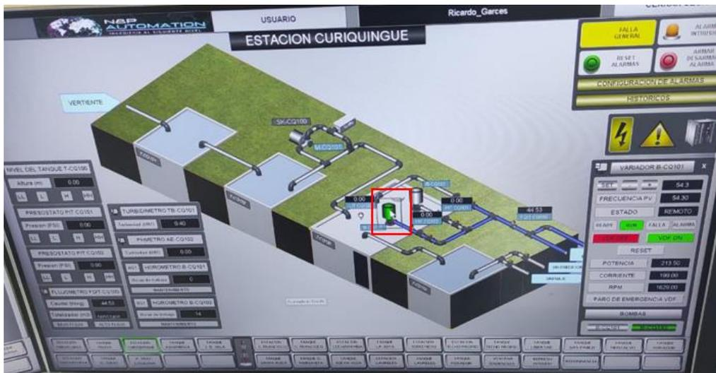
Se comprueba la integración del medidor PM5560, en la Figura 65 donde se observa que, en la pantalla del medidor de energía, se muestran datos como el voltaje, corriente, potencia, por lo tanto, existe comunicación entre el sistema SCADA con el medidor existente en campo.
