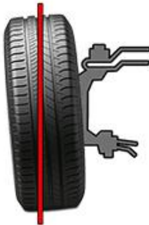
Desgaste acelerado en el exterior
