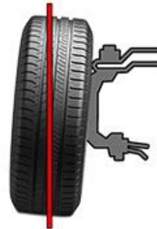
Desgaste acelerado en el interior
