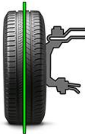
Rueda alineada desgaste uniforme
