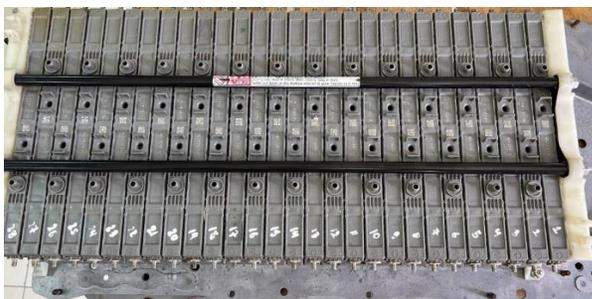
Una vez desarmada la batería se realizó una inspección visual de esta. Revisar si alguno de los packs esta estallada o inflamada, además de verificar si en su base existe corrosión.
