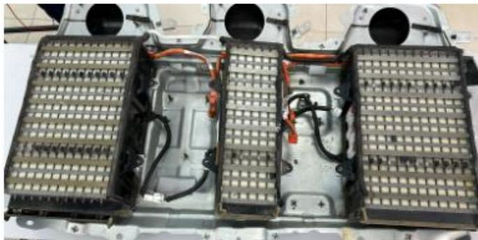
Como siguiente paso, se retiró el soporte inferior y desconectando módulos en serie de las baterías, los 30 pack de las baterías se pueden apreciar
