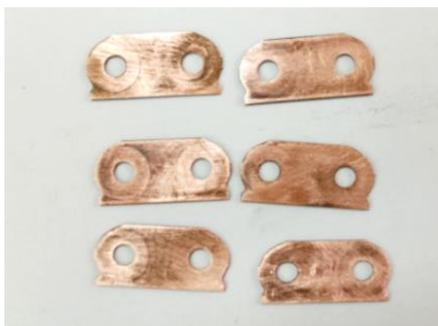
Es muy frecuente que las chapas y conectores se sulfaten, por lo que es necesario retirar la batería del vehículo para poder retirar las protecciones y limpiarlas mediante métodos
