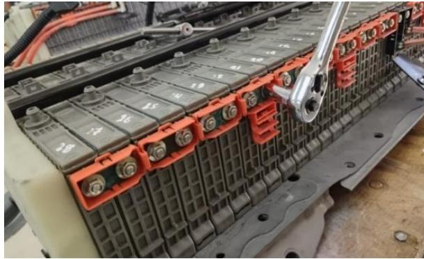
Se quitaron los ductos de ventilación y los sensores de temperatura.
