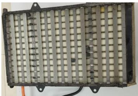
Una vez desarmada la batería es importante realizar una inspección visual de esta. Revisar si alguno de los packs está estallada o inflamada, además de verificar si en su base existe corrosión.
