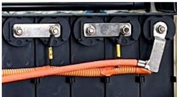
Como se observa en la **figura 68** el estado de las chapitas y conectores es buena, no se visualiza la presencia de corrosión o sulfatación, lo que indica que la batería fue conservada de buena manera.
