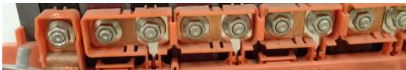
El sistema de conexión y paso de voltaje se encuentra en buenas condiciones, ya que este no posee sulfato por efecto el conjunto de baterías está operando con normalidad.
