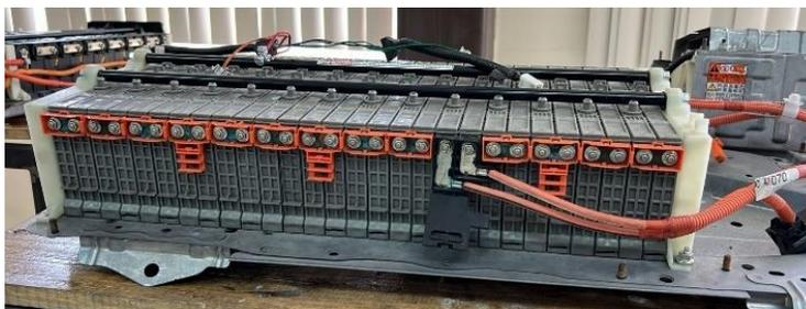
Una vez retiradas las tapas de seguridad se observó la conexión en serie de las baterías, los cables de control de voltaje de la ECU y lo más importante se verificó la existencia de sulfatación en la batería.
