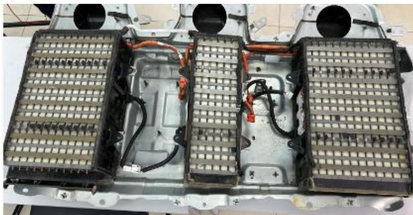
Completando el proceso de armado de la batería se procede a tomar el valor total que entrega la batería repotenciada al vehículo híbrido.
