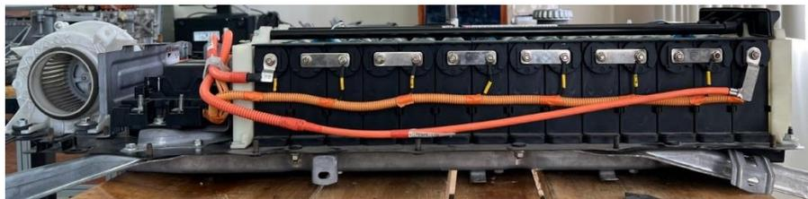
Se retiro las tapas de protección de los conectores y sensores de temperatura.
