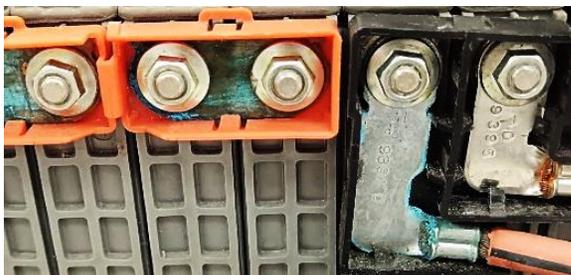
Se aflojaron las tuercas de cada pack, esto con el propósito de extraer las chapas sulfatadas y hacerles un mantenimiento.
