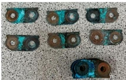
Tener sulfatación en los conectores y chapitas genera resistencia al paso de voltaje y provoca aumento de la temperatura. La sulfatación a largo plazo daña el estado de la batería y acorta su vida útil.
