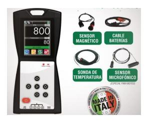
Nota. Se observa el medidor de revoluciones de la marca BrainBee modelo MGT 300-EVO. Obtenido de (GLOBALTECH, 2021).
