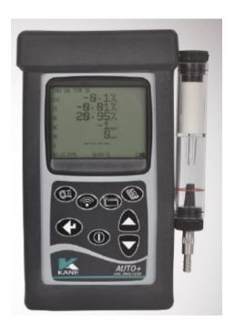
*Nota.* La imagen muestra el analizador de gases KANE modelo AUTOPLUS 4-2 con su respectiva trampa de agua y filtro de partículas. Tomado de (GLOBALTECH, 2024).
