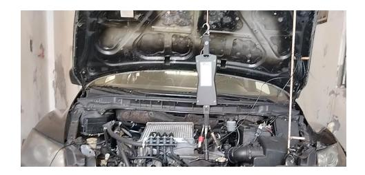
Nota. Se identifica la conexión del MGT 300 EVO para el registro de revoluciones por medio del sensor captador de vibraciones, la selección de cilindros del motor, la temperatura.
