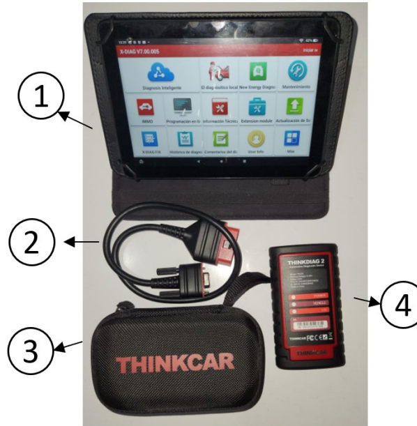
Escáner Automotriz con sus accesorios: interface (1), cable OBD2 (2), estuche (3), escáner (4).
