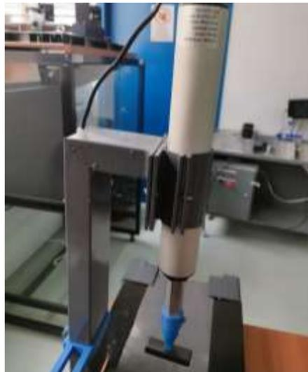
En la parte inferior del actuador se coloca un sello el mismo que cumple la función de indicar el número de pieza, el sellador se muestra en la figura 43.
