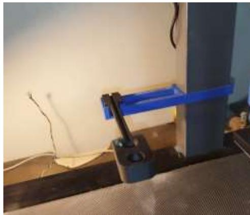
Finalmente se une las piezas del separador de cortes de tela, el mismo que está hecho en PLA+. Para el soporte de las telas del separador se usa una base de una contadora de hojas, mientras que el eje del rodillo se coloca en las chumaceras para que gire de manera suave y eficiente. El separador se muestra en la Figura 45.
