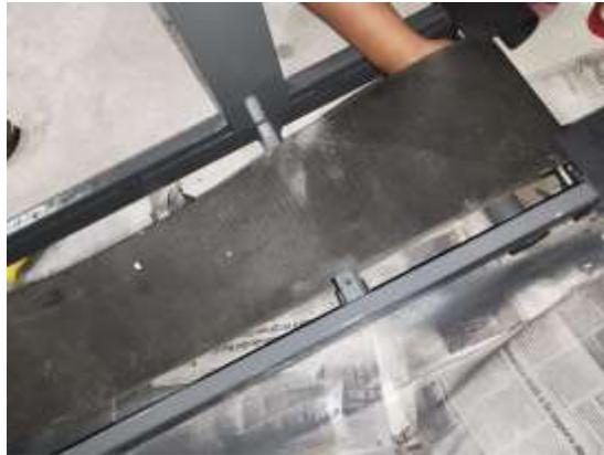
Posterior a la construcción de la estructura de la máquina, se realiza la colocación de los rodillos, el motor y la banda transportadora, como se observa en la figura 40.
