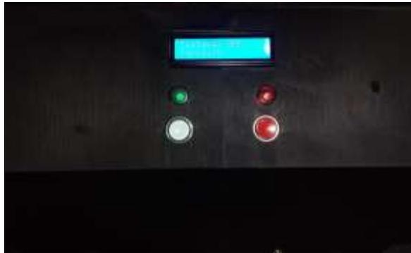
Teniendo todas las conexiones se ubica todos los componentes en la caja y se coloca el panel de control con las botoneras, la misma que se compone de un botón e indicador tanto para iniciar como para detener el proceso y la pantalla LCD para mostrar el conteo de los cortes de tela y el estado del sistema.
