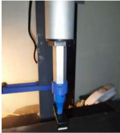
Para la etapa de conteo, en el brazo que sujeta el actuador lineal se coloca una base para el sensor mismo que este hecho de PLA+ y se ajusta con un perno para evitar que se resbale y caiga. La ubicación del sensor es importante ya que es el que se encarga de detectar los cortes de tela contarlos y enseguida accionar el actuador lineal para que los selle, por tal motivo debe ubicarse en un lugar estratégico como se observa en la figura 44.
