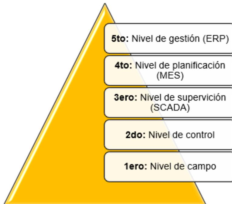
El "nivel de campo", comprende todos los elementos físicos de la industria, como, por ejemplo: actuadores y sensores, siendo el nivel más bajo de la pirámide. El siguiente nivel, el "nivel de control", engloba dispositivos de control tales como tarjetas de control, PLC's, etc. En el tercer nivel, denominado "nivel de supervisión", se encuentran los sistemas SCADA, encargados de supervisar, controlar y adquirir datos. El cuarto nivel, denominado "nivel de
