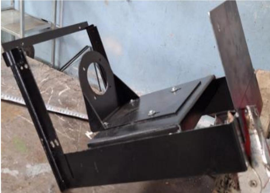
Con el fin de cumplir la meta de funcionalidad se construye el módulo con base a las medidas de la carcasa del electrodinamómetro, para que pueda insertarse correctamente en los casilleros del gabinete del laboratorio de Máquinas eléctricas.
