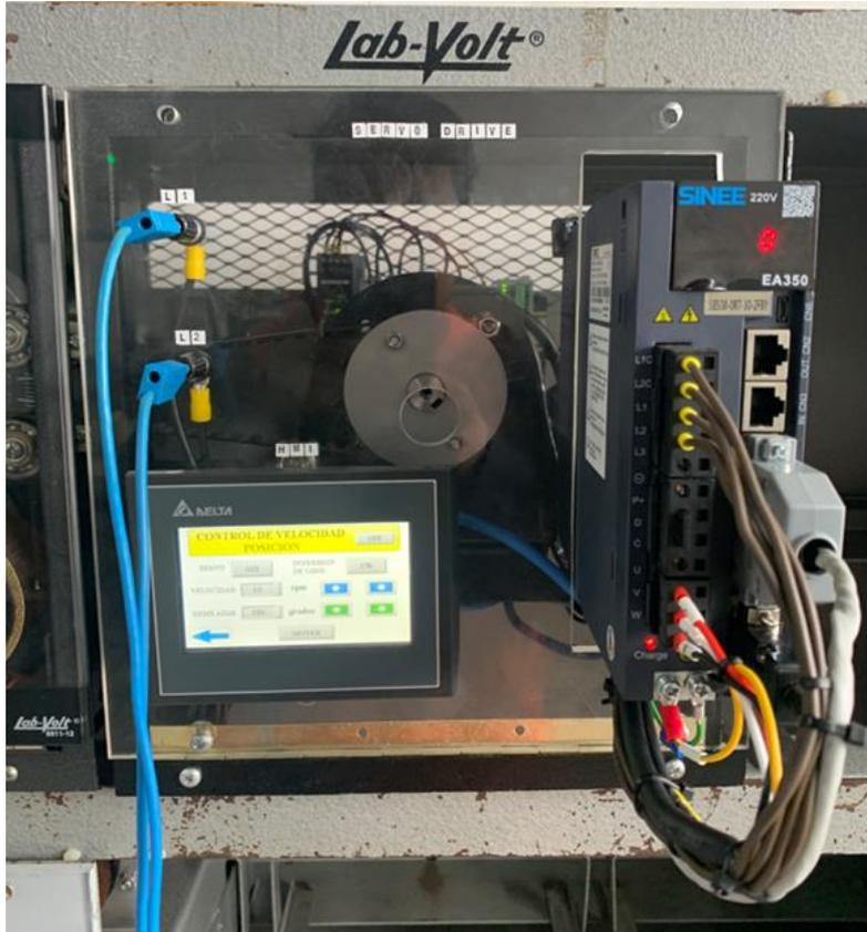
Dentro de la prueba de control de posicionamiento se procede a variar tanto velocidad y posición a un movimiento rotacional máximo de  $360^\circ$ .
