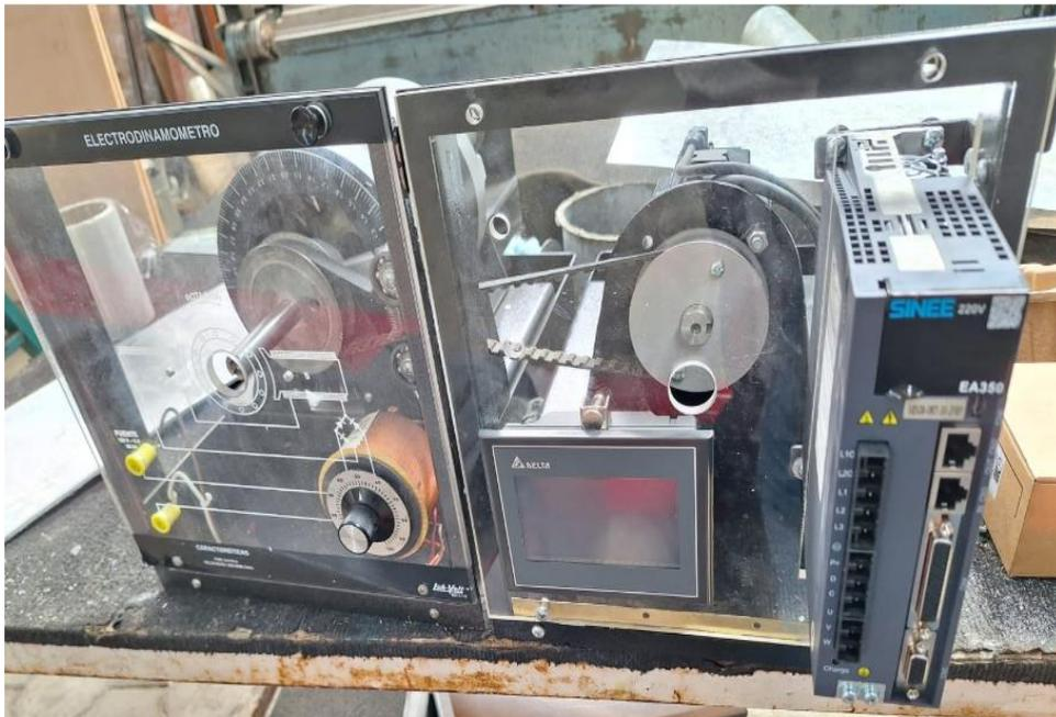
Por último se verifica que el módulo esté bien construido montando las piezas y componentes, se inspecciona que todos los componentes se encuentren bien ubicados y las piezas bien fijadas, en el caso de encontrar una falla se realiza la etapa de corrección ya sea de los cortes para el HMI y el servo drive o la posición del servomotor que debe estar en paralelo al electrodinamómetro, donde se prueba conectando ambos módulos mediante la banda de transmisión.
