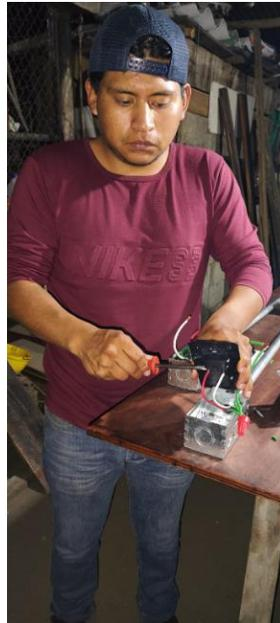
*Nota.* Conectado al interruptor termomagnético Square D de 1 polos de 20 A.
