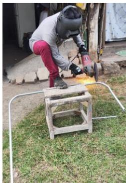
*Nota.* Al realizar los cortes del tubo conduit EMT de  $\frac{1}{2}$ " con la moladora.
