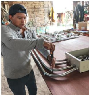
*Nota.* Para sujetar cada equipo se utilizó el desarmador estrella y se atornilla con tornillos de cabeza grande de ½”.
