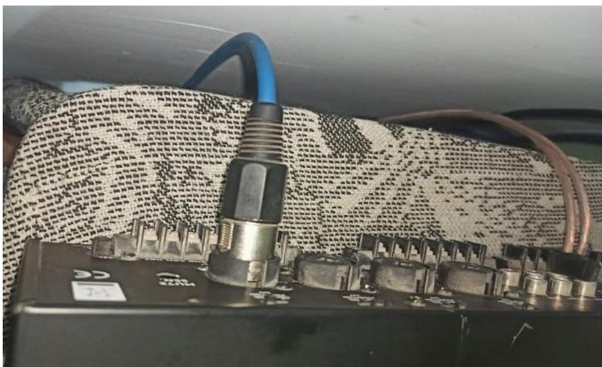
*Nota.* En la figura se visualiza como se enlaza la conexión mediante un cable XLR estéreo a plug 3.5 entre el TV-BOX y el amplificador.
