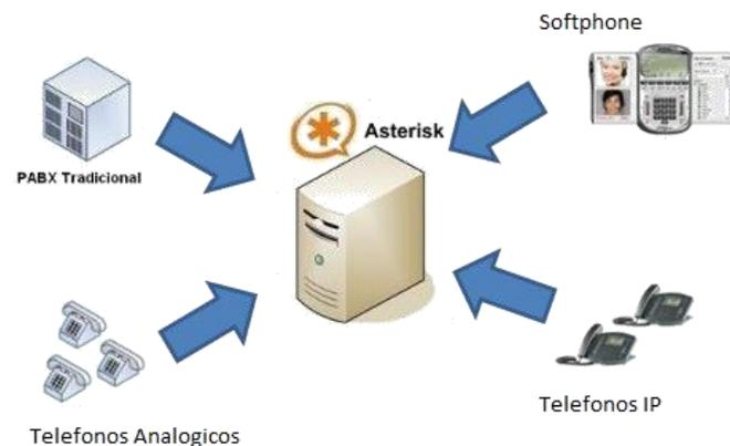
*Nota.* La figura muestra como una central Asterisk permite conectar diferentes tipos de terminales para establecer llamadas. Tomado de *¿Qué es Asterisk?*, por TrizClass, (2013)
