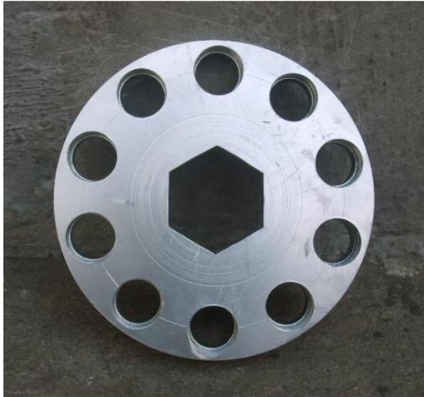
Figura 4.15.- Placa redonda terminada
