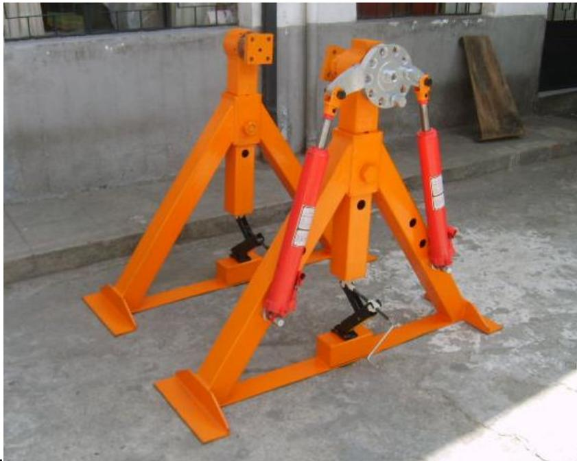
**Figura 2.4.- Soporte hidráulico 1**
