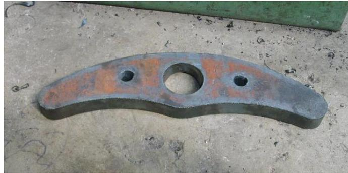
**Figura 4.10.- construcción del brazo palanca**
