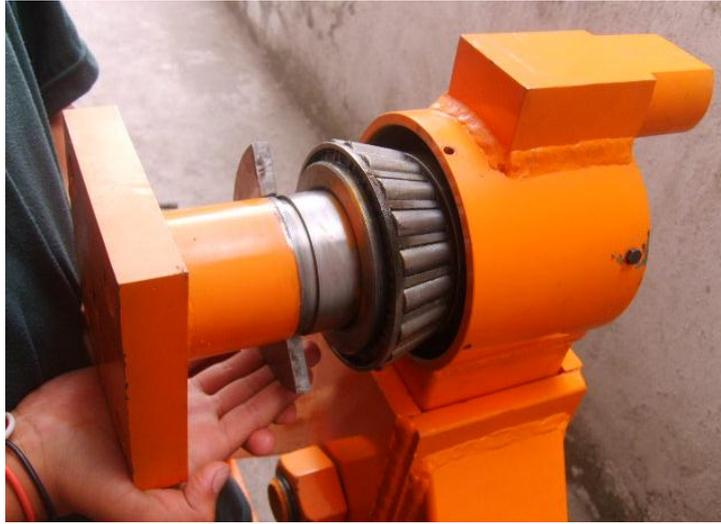
**Figura 4.24.- Colocación del eje**
