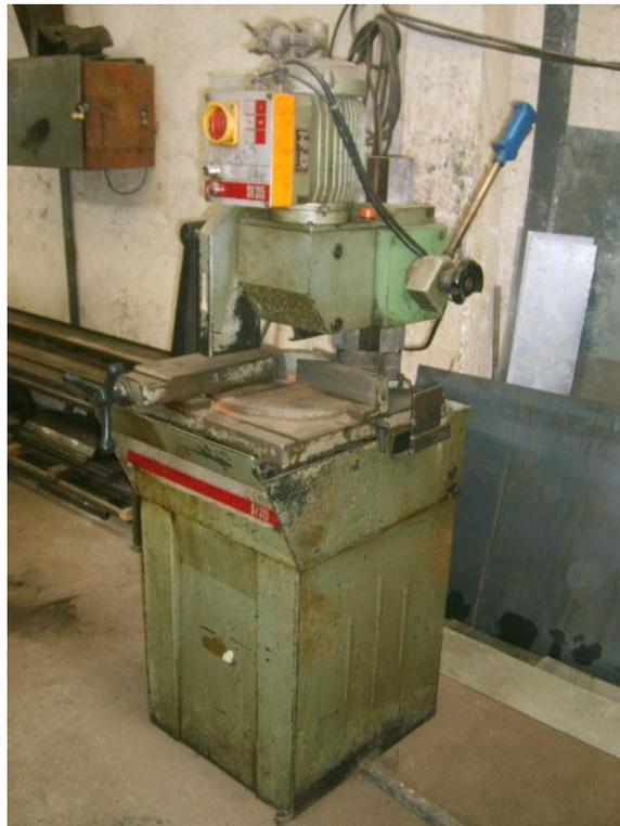
Figura 4.1.- Cortadora de disco
