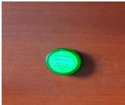
*Nota.* Luz piloto indicadora de conexión y desconexión de energía en las mesas de trabajo del laboratorio.
