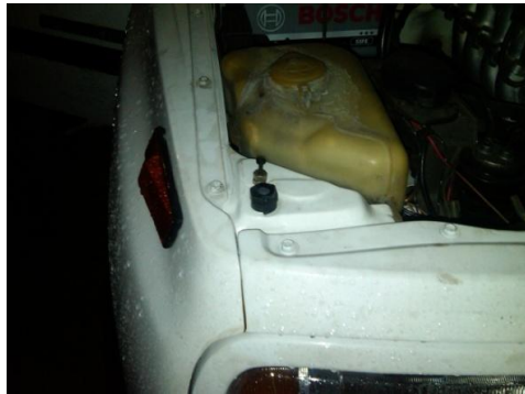
Fuente: Patricio Pazmiño y David Cerda Figura 4.42 Pulsador de puerta de capot
