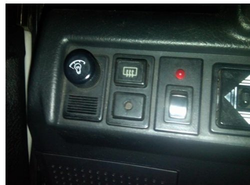
Figura 11 Switch de habilitación de alarma de puertas
