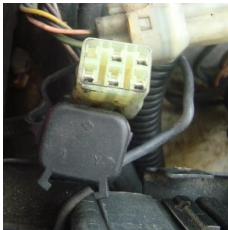
Figura 2.15 Conector OBDI del vehículo Suzuki Sidekick
