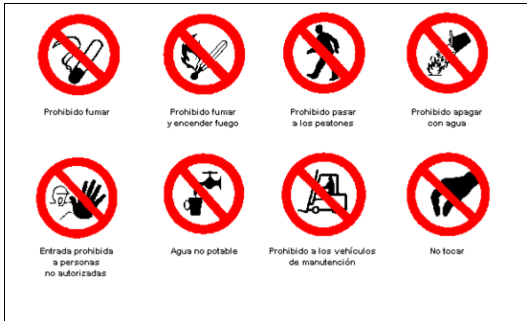
FIGURA 4.17. Señales de Prohibición
