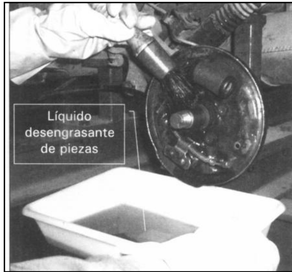
FIGURA 4.21. Limpieza de un freno de tambor desmontado FUENTE: Bernardo, L. Seguridad en el Mantenimiento de Vehículos
