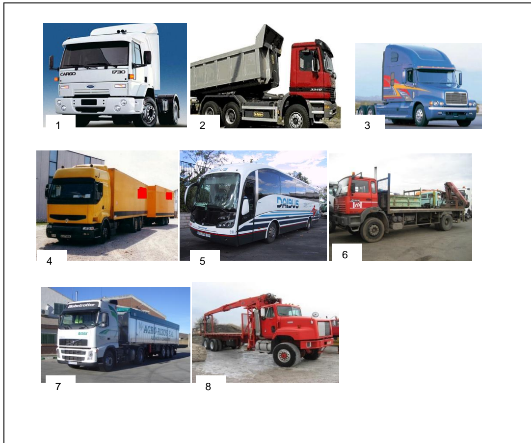
FIGURA 2.17. Tipos de Vehículos pesados: 1. Camión; 2 Volquete; 3 Tracto camión; 4 Tren de vía; 5 Autobús; 6 Plataforma; 7 Remolque; 8 Grúa; 9 Tanquero.
