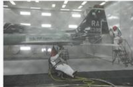
MÉTODO DE BLASTING CON ABRASIVOS PLÁSTICOS
