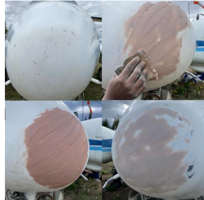
Lijado y aplicación de la masilla para mantener el nivel de la superficie y mejorar la adherencia de la pintura en el Radome.
