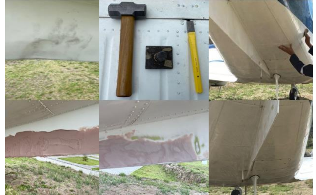
Corrección de los hundimientos en el single after body strakes
