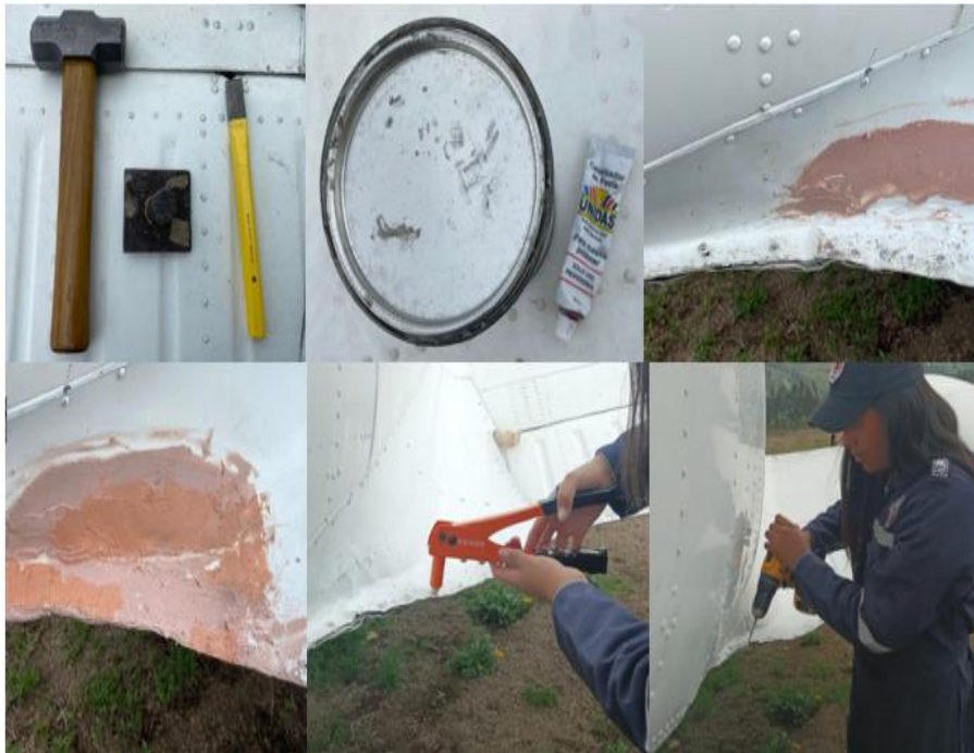
Corrección estructural en la raíz del ala.
