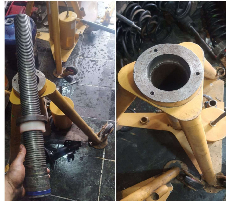
Reemplazo de los O-ring en mal estados
