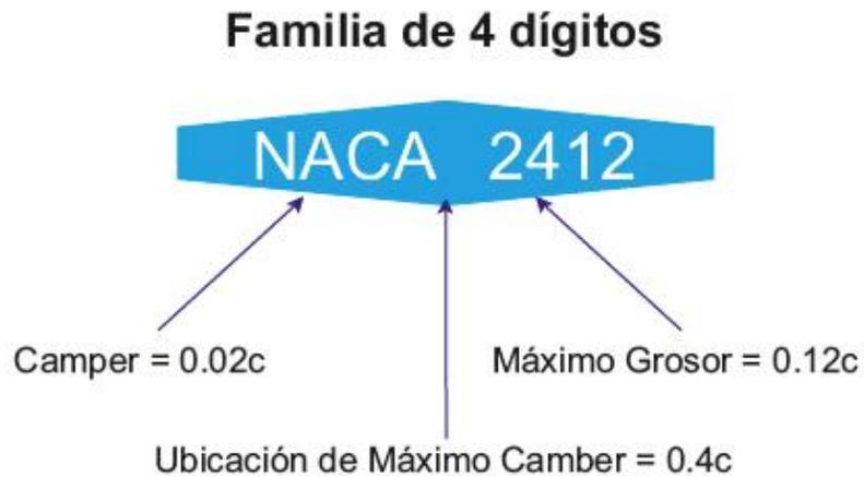
*Nota.* Nomenclatura de un perfil aerodinámico NACA de 4 dígitos. Tomado de Carmona, A (1999)
