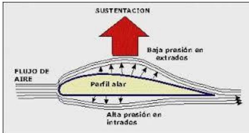
*Nota.* Presiones generadas en un perfil aerodinámico. Tomado de APUCA
